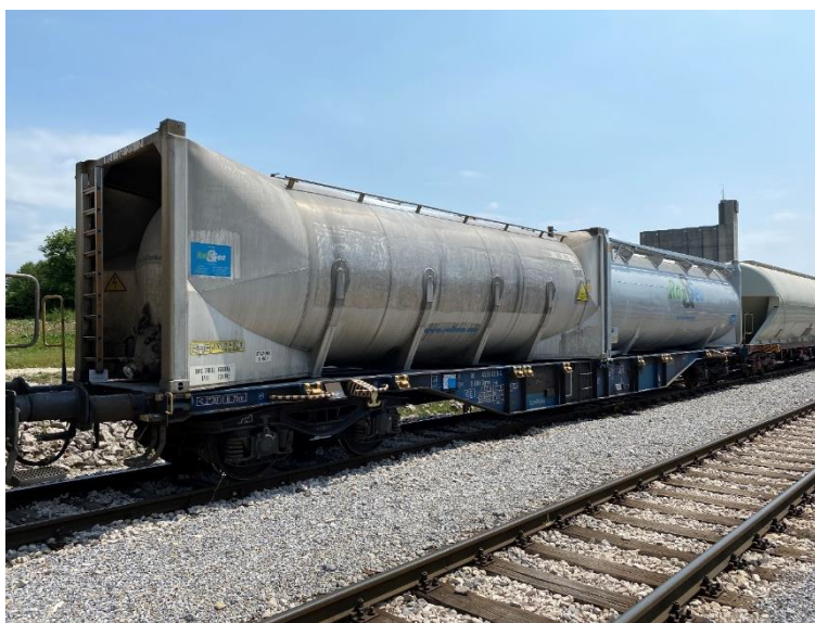
Slika 34. Sgnss vagon s kontejnerima u Gospiću
