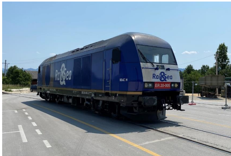
Slika 28. Lokomotiva Siemens ER 20 na industrijskom kolosijeku tvrtke Calcit Lika
