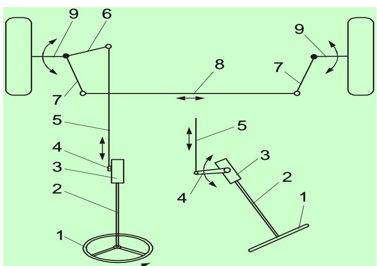
Slika 4.6. Upravljački mehanizam
