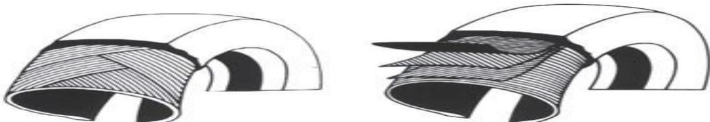
Slika 4.5. Konstrukcija dijagonalnog i radijalnog pneumatika
