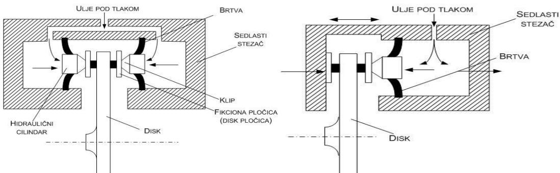
Slika 4.2. Disk kočnice s fiksnom i pomičnom stegom
