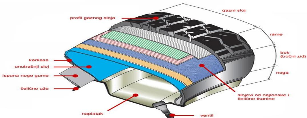
Slika 4.4. Konstrukcija pneumatika
