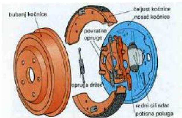
Slika 4.1. Bubanj kočnice
