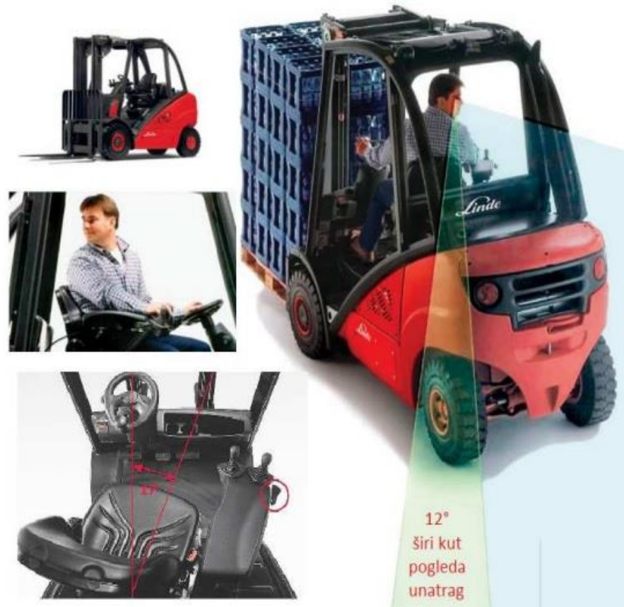
Slika 4. Linde viličar sa zaokretnim sjedalom
