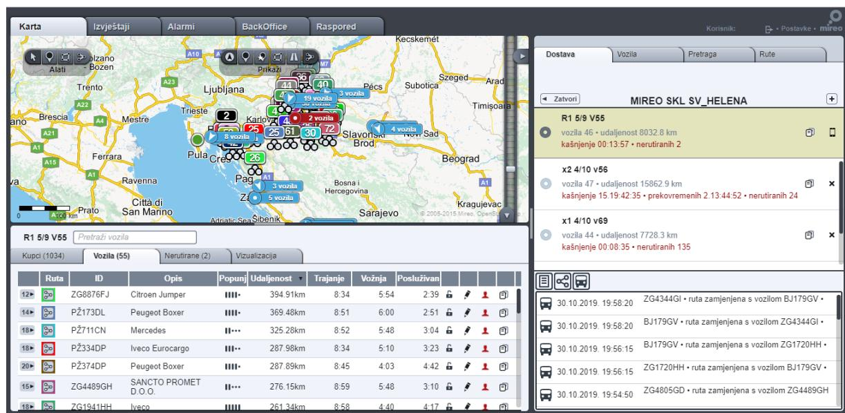
Slika 8. Primjer rutiranja vozila putem Mireo sustava
