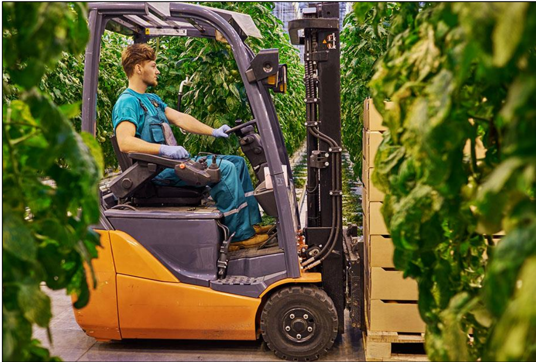
Slika 10. Električni čeonni viličar Izvor: [28]
