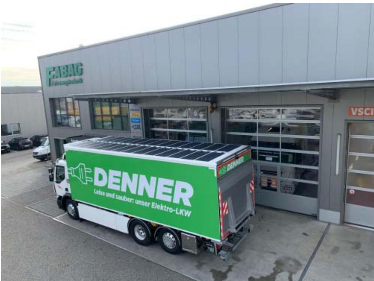
Slika 8: Električni kamion sa solarnim čelijama
