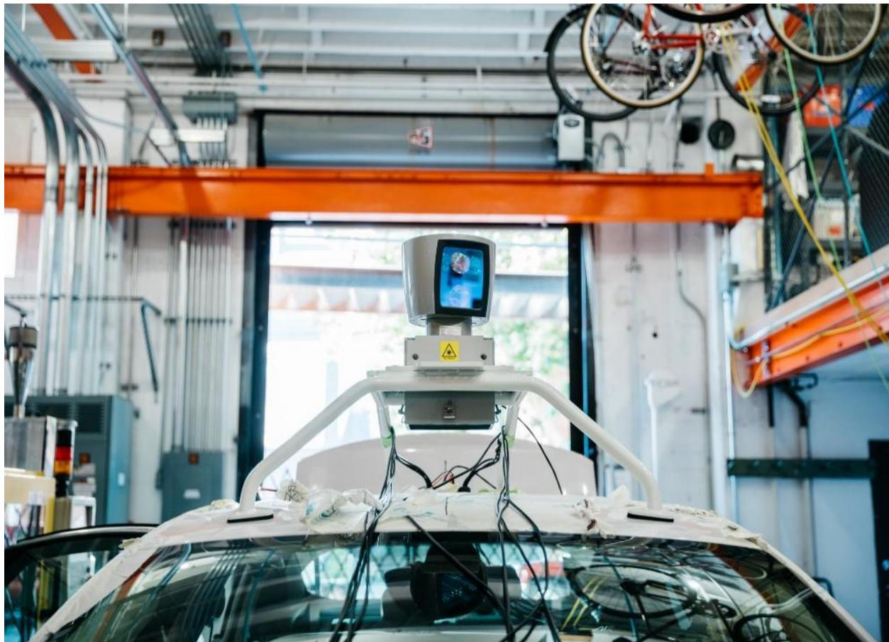
Slika 8. Prikaz LiDAR senzora pričvršćenog na krov autonomnog vozila<sup>24</sup>
