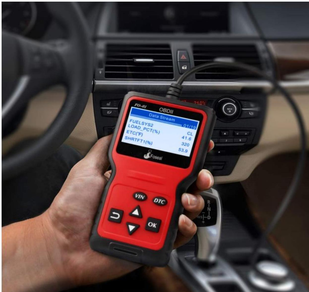
Slika 1. Prikazuje OBD skener u radu <sup>11</sup>
