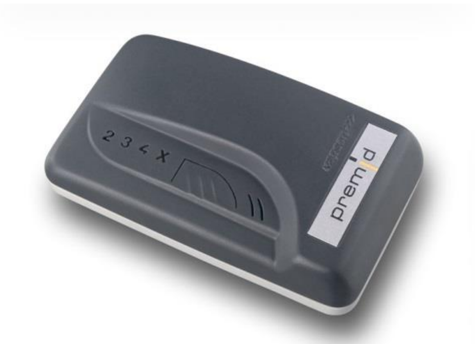
Slika 4: Transponder za naplatu cestarine
