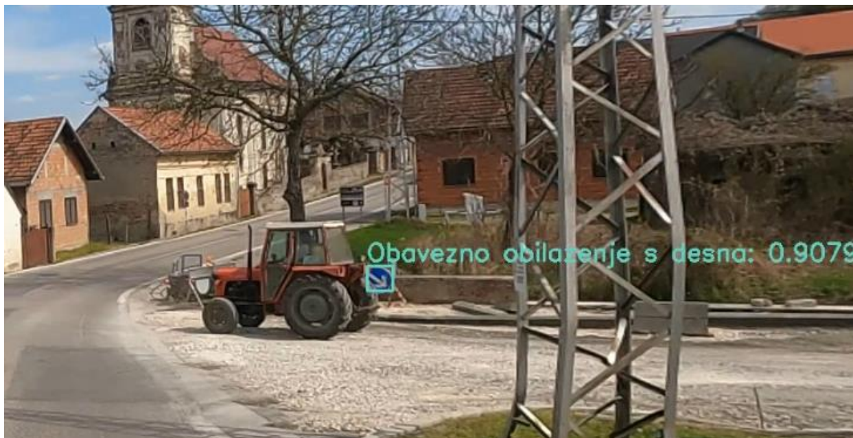
Slika 32: Prepoznavanje zaklonjenog znaka obavezno obilaženje s desna
