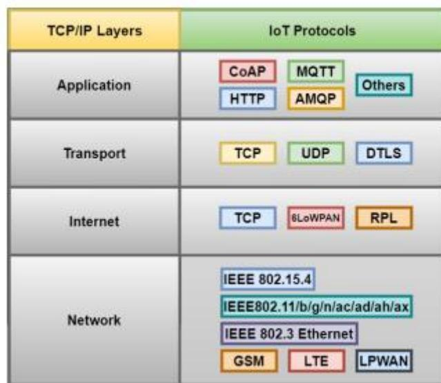
Slika 4: TCP/IP slojevi u skladu s IoT protokolima
