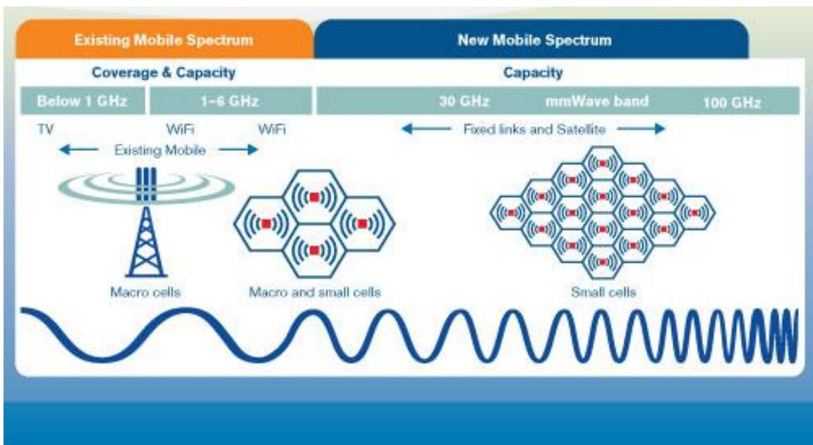
Slika 2. Prikaz vrsta antena u odnosu na korištenu frekvenciju
