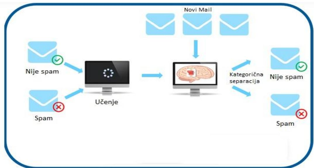
*Slika 16. Pojednostavljeni prikaz nadziranog strojnog učenja*
