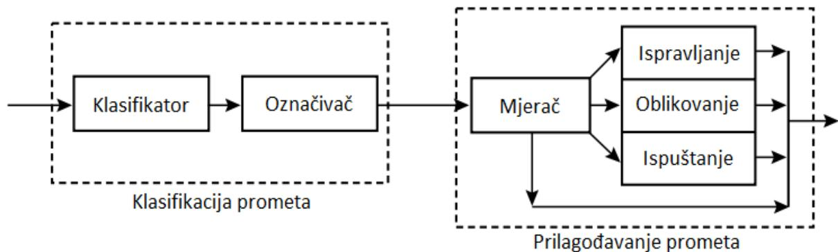
Slika 13. Komponente modula za klasifikaciju i prilagođavanje prometa
