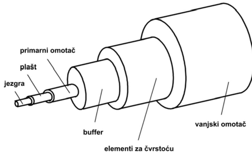
*Slika 3.: Izgled svjetlovodnog kabela[4]*
