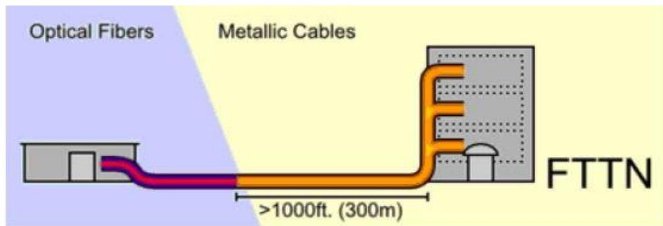
Slika 7. Optičko vlakno do ormarića/distribucijskog čvora Fiber to the Cabinet/Node[18]
