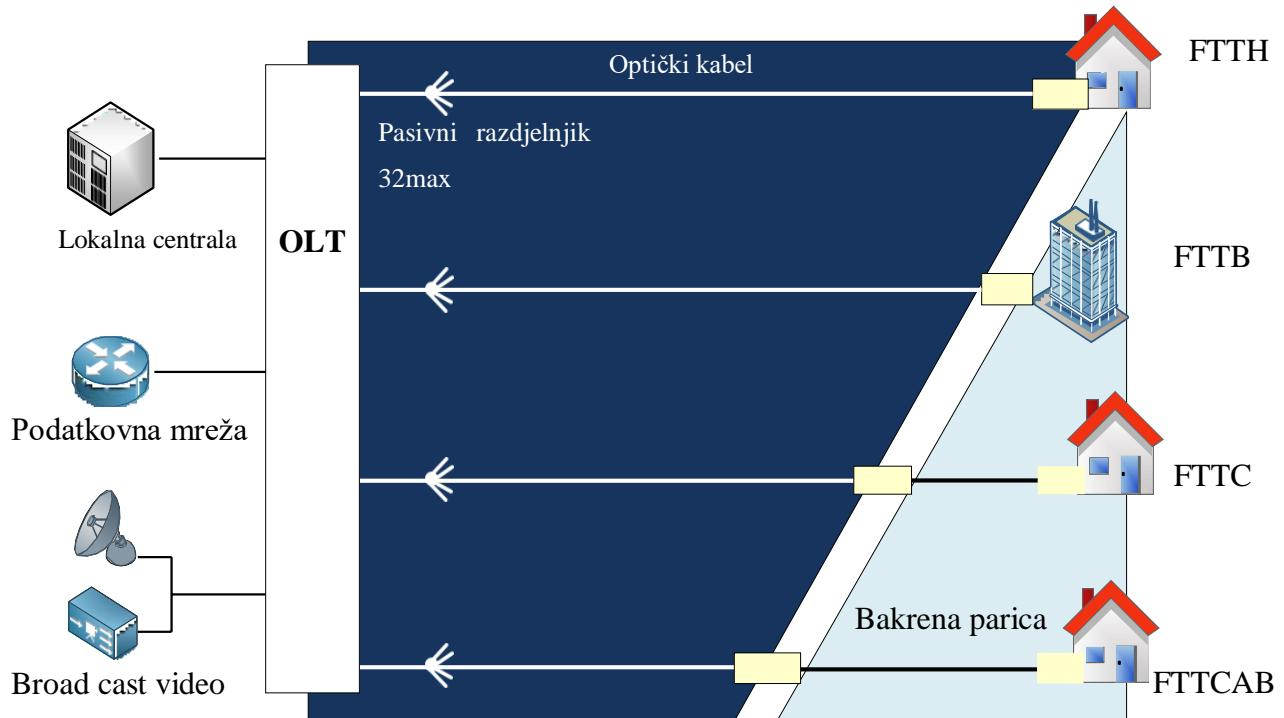
*Slika 5. Prikaz načina spajanja optičkog kabela do preplatnika[13].*
