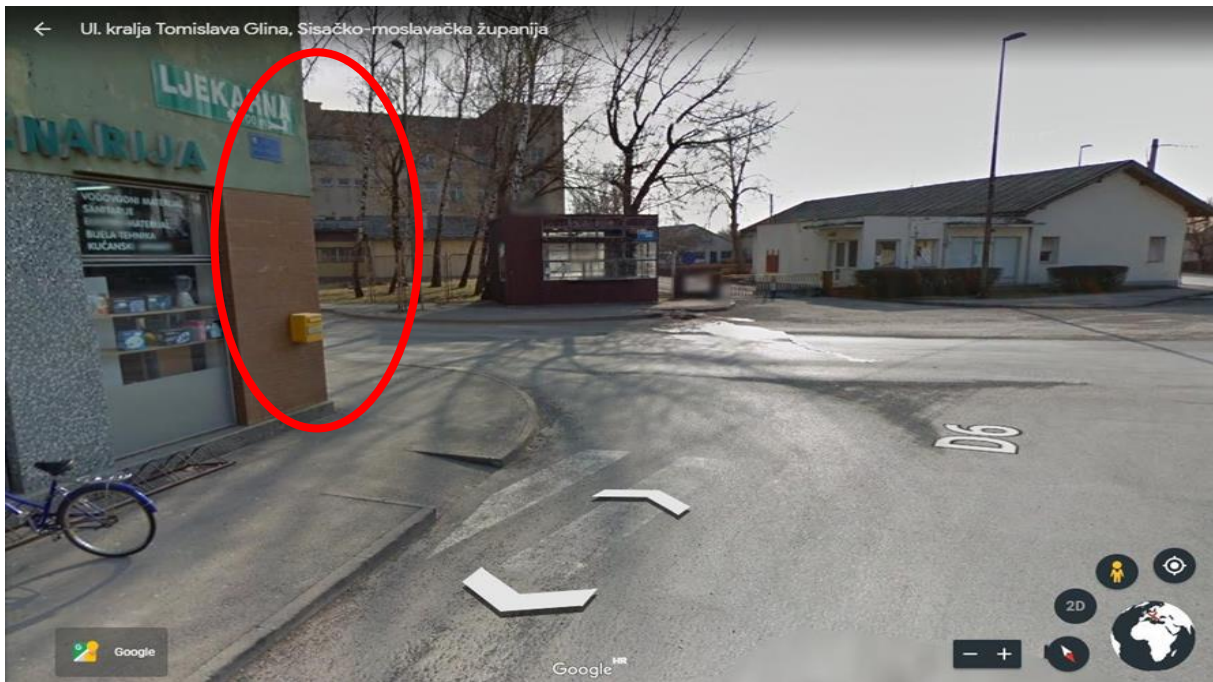
Slika 14. Prikaz loše horizontalne signalizacije i infrastrukture koja smanjuje preglednost
