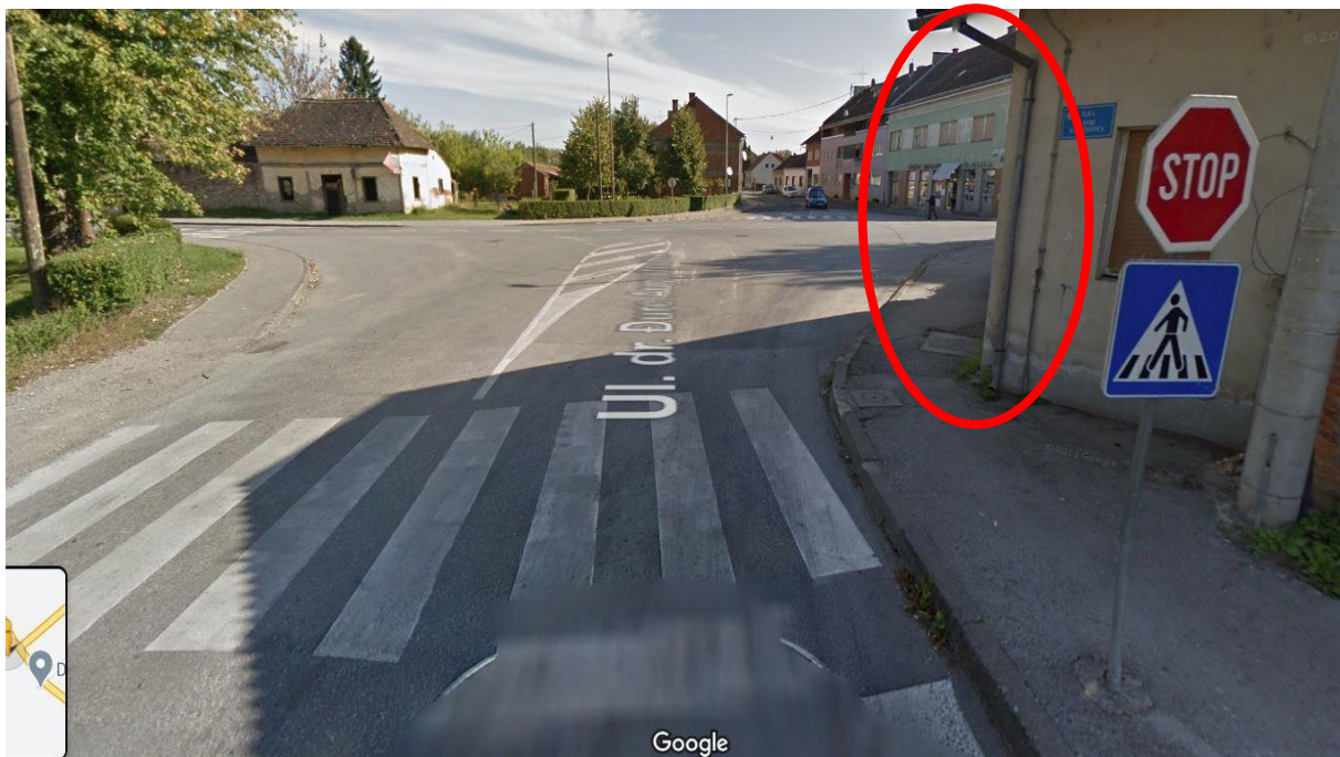
Slika 17. Prikaz uvučene signalizacije i infrastrukturno objekta
