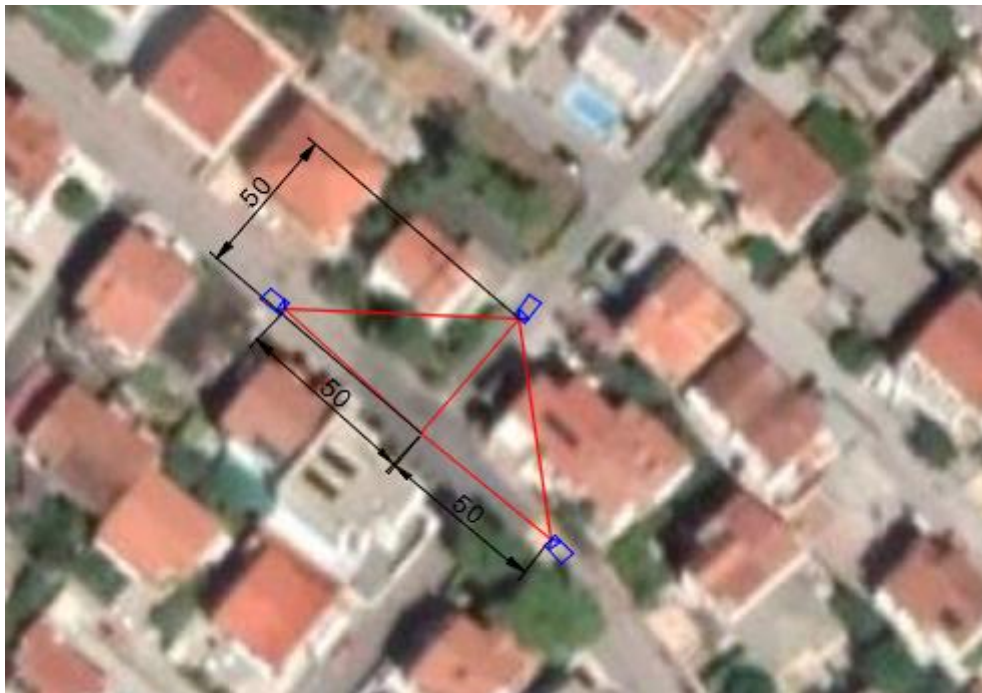
Slika 27. Trokut preglednosti sa potrebnim trokutom preglednosti
