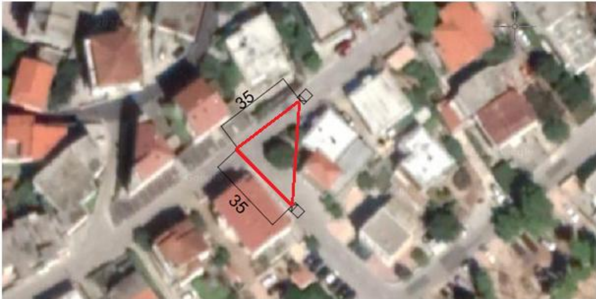
Slika 24. Trokut preglednosti sa preporučenom duljinom preglednosti
