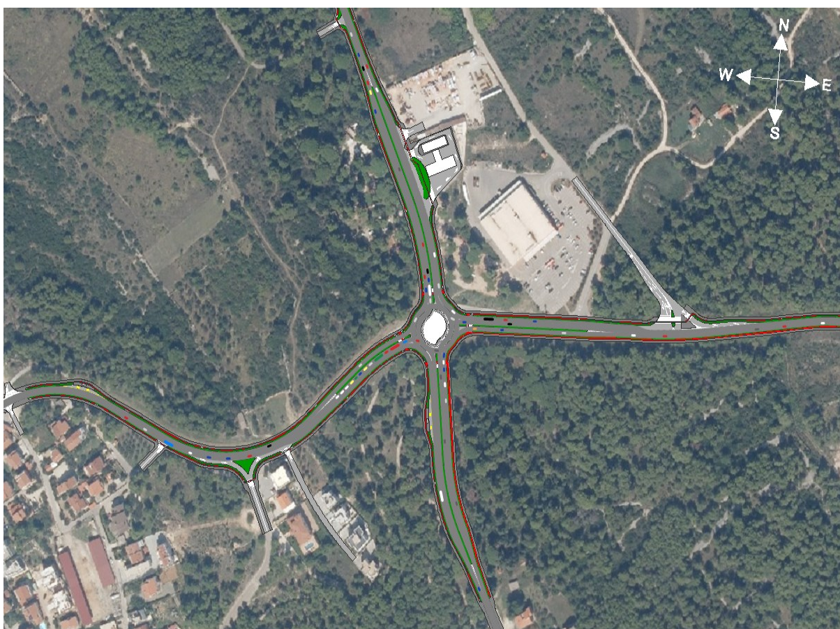
Slika 6.3. Simulacijski model idejnog rješenja 2 u PTV Vissim-u
