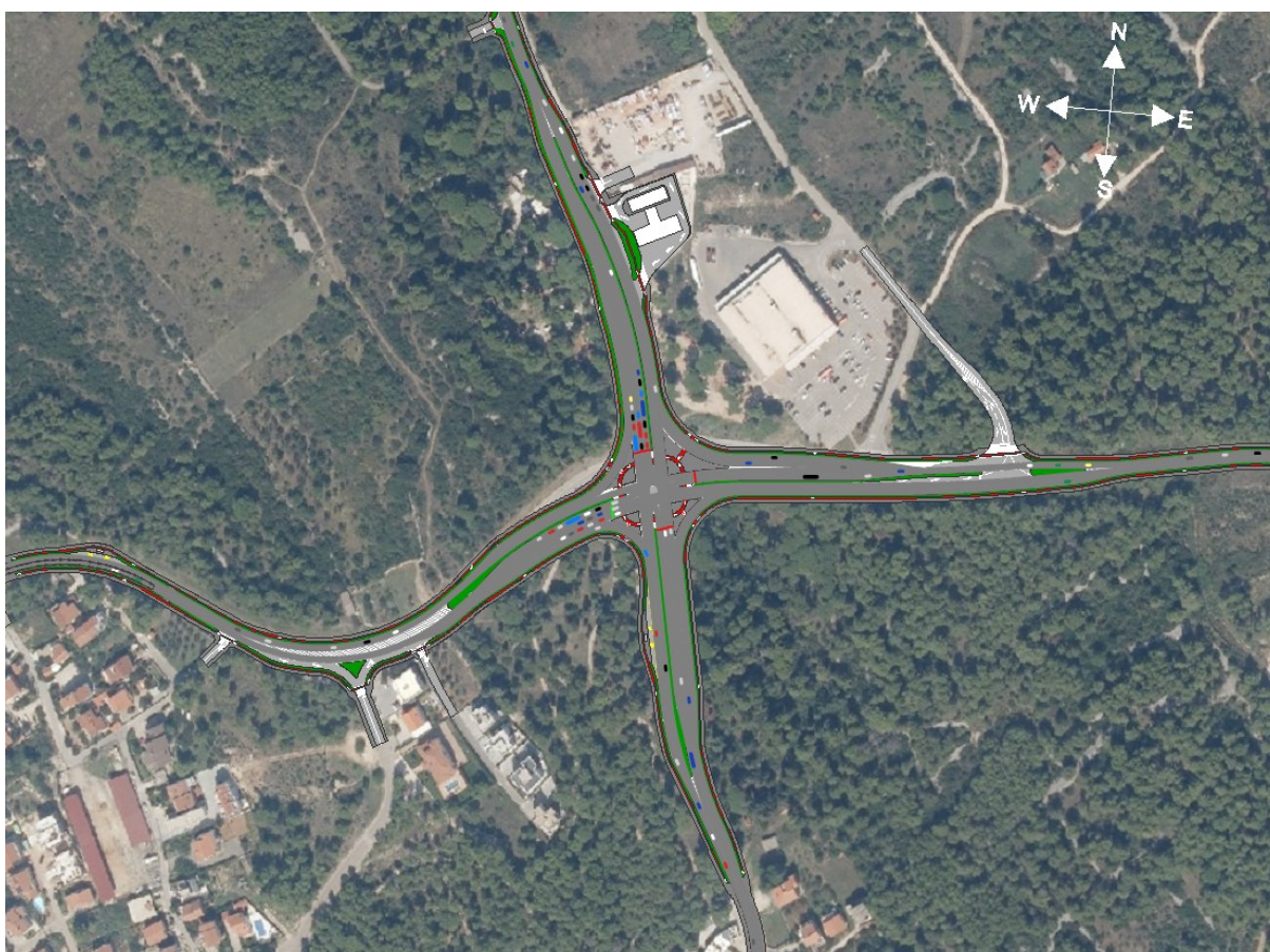
Slika 6.2. Simulacijski model idejnog rješenja 1 u PTV Vissim-u
