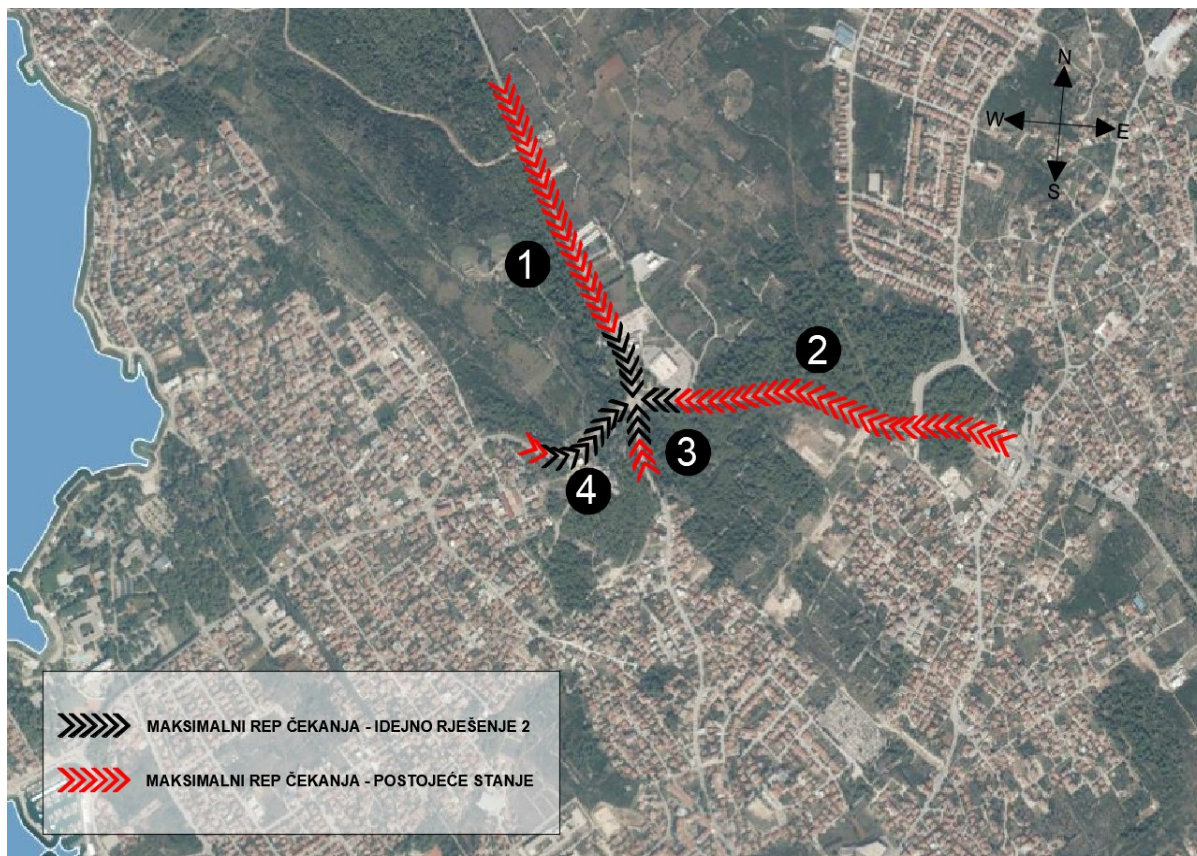
Slika 6.5. Komparacija postojećeg stanja i idejnog rješenja 2 prema maksimalnom repu čekanja na pojedinom privozu
