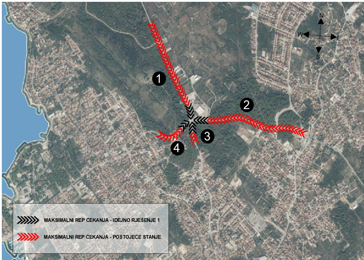
Slika 6.4. Komparacija postojećeg stanja i idejnog rješenja 1 prema maksimalnom repu čekanja na pojedinom privozu
