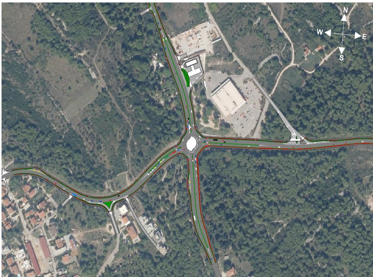
**Slika 6.3.** Simulacijski model idejnog rješenja 2 u PTV Vissim-u
