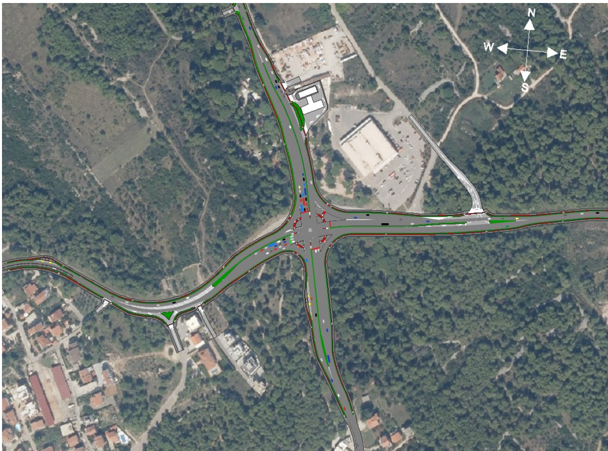
Slika 6.2. Simulacijski model idejnog rješenja 1 u PTV Vissim-u
