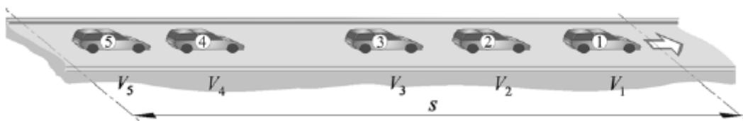
Slika 2-4. Način mjerena srednje prostorne brzine na promatranoj dionici
