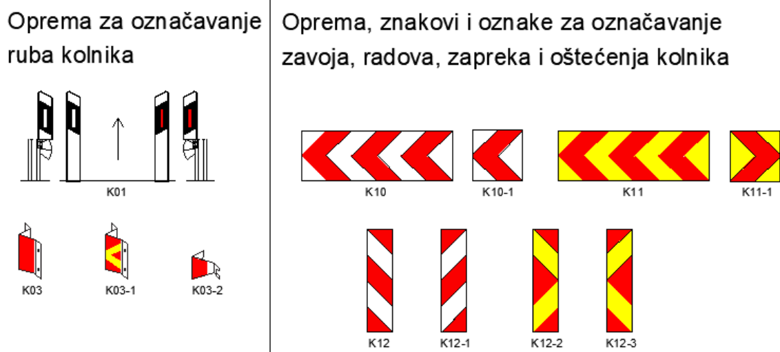
Slika 6. Prometna oprema za označavanje zavoja
