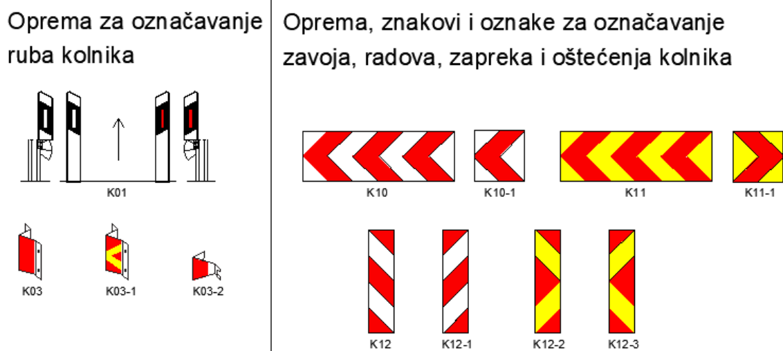
Slika 6. Prometna oprema za označavanje zavoja
