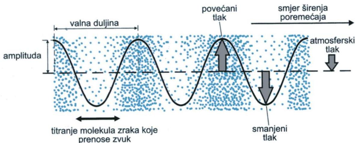
Slika 6. Fizikalni parametri zvučnog vala, IZVOR: [13]
