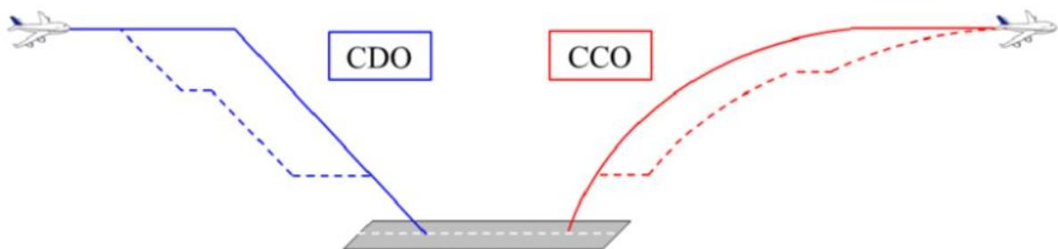
Slika 20. Prikaz CDO, CCO i standardne procedure, IZVOR: [20]
