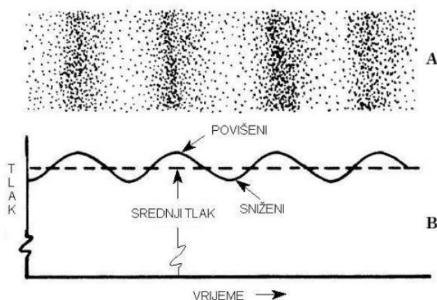
Slika 7. Zvučni tlak, IZVOR: [5]
