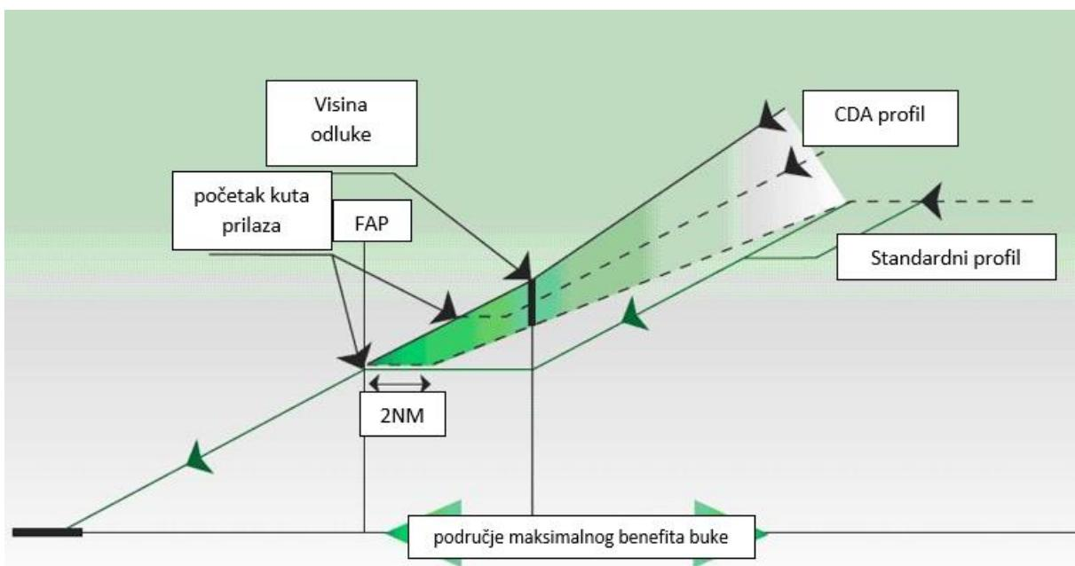
Slika 19. Usporedba CDO i standardne procedure spuštanja, IZVOR: [19]
