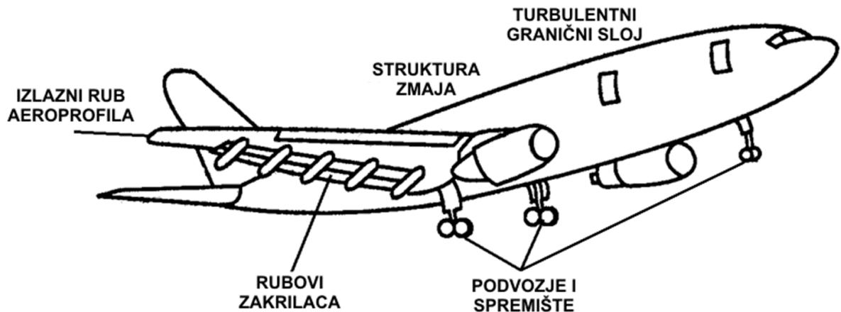
Slika 1. Izvori buke zbog aerodinamičkog opstrujavanja, IZVOR: [5]
