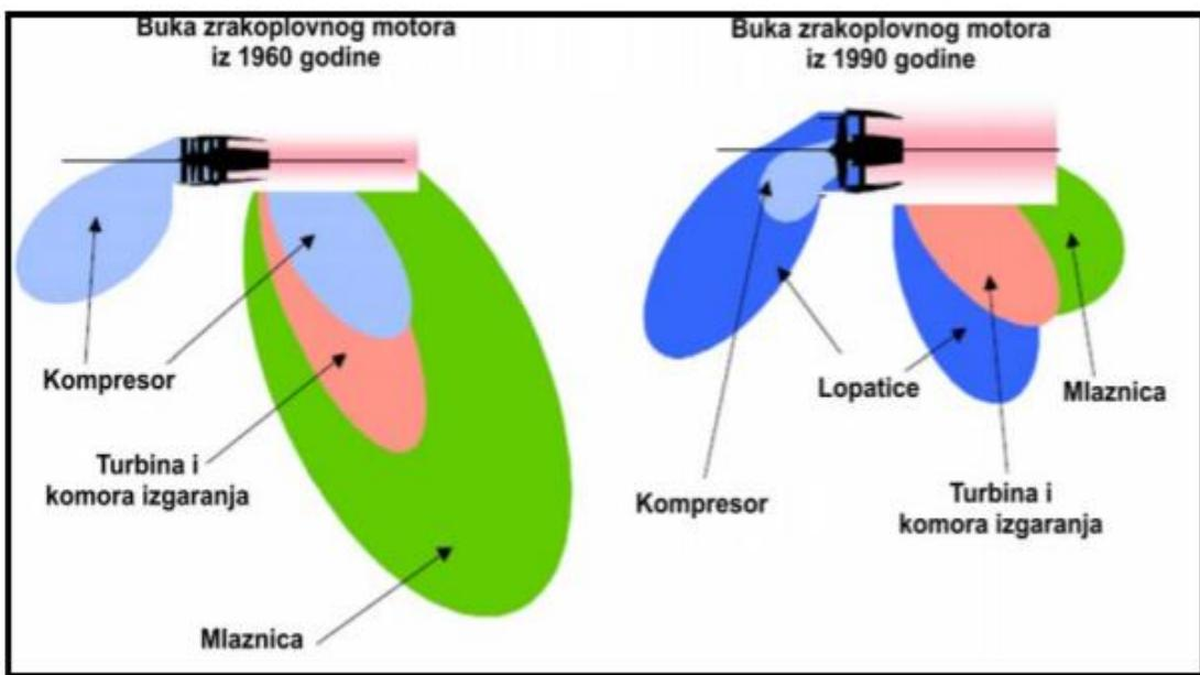
Slika 4 Usporedba buke zrakoplovog motora iz 1960. i 1990. godine, IZVOR: [5]
