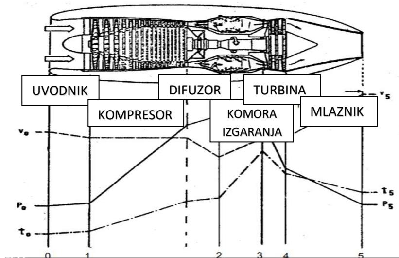
Slika 2 Prikaz glavnih dijelova mlaznog motora, IZVOR: [4]
