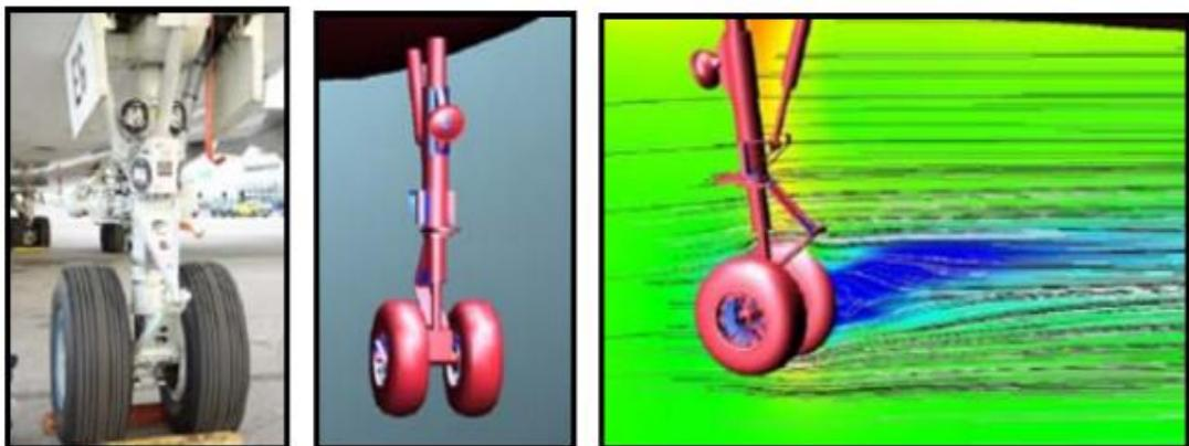
*Slika 6 Prikaz analize opstrujavanja zraka oko nosnog kotača Boeing-a 747, IZVOR: [5]*
