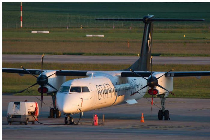
Slika 3.3: Zrakoplov priključen na zemaljski izvor električne energije Izvor: http://www.wikiwand.com/hr/Oprema_u_zra%C4%8Dnoj_luci#/Zemaljski_agregati_(GPU) , preuzeto 3.7.2020
