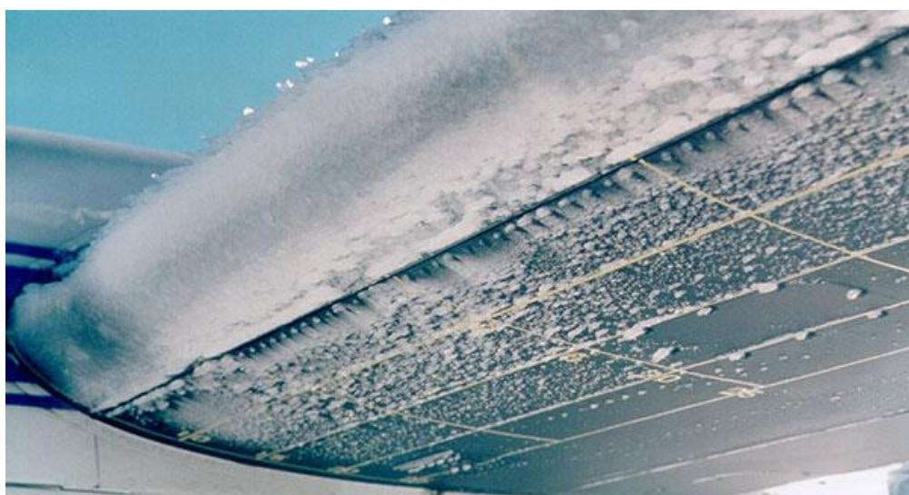
**Slika 15.** Prikaz leda na napadnoj ivici krila zrakoplova [23]
