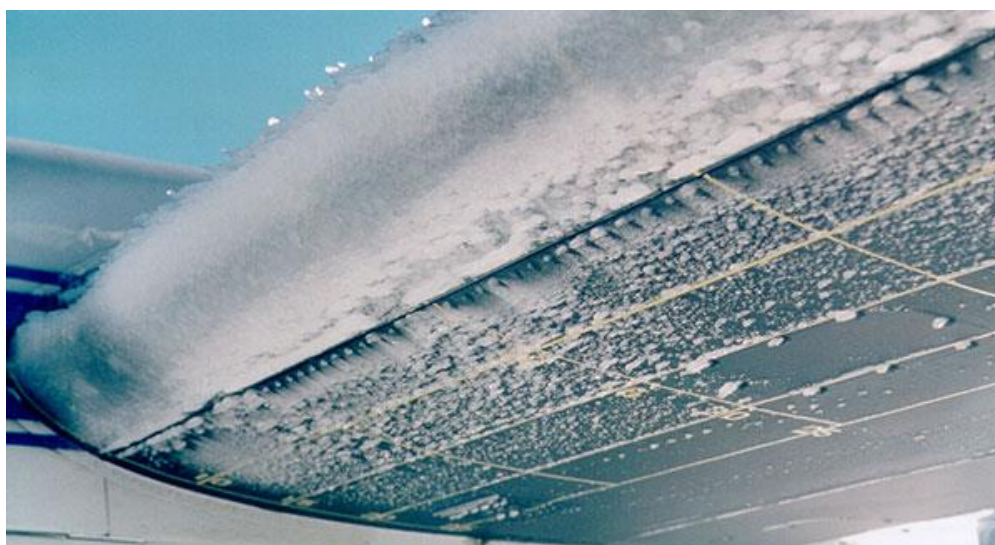
Slika 15. Prikaz leda na napadnoj ivici krila zrakoplova [23]
