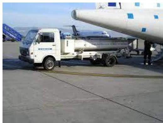
Slika 15. Vozilo za opskrbu zrakoplova vodom [46]
