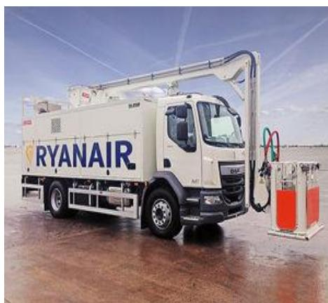
Slika 19. Vozilo za odleđivanje i zaštitu zrakoplova od zaleđivanja [53]
