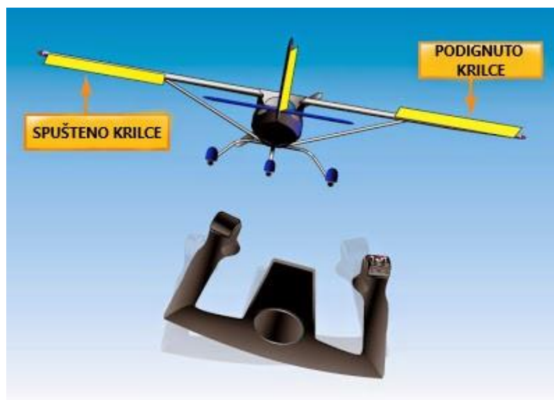
Slika 6. Položaj krilca kod pomicanja upravljačke palice
