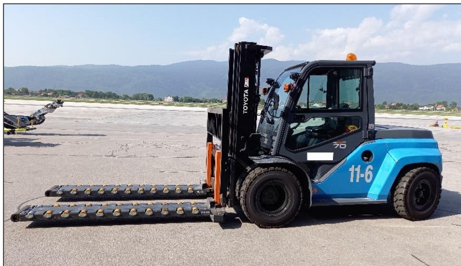
Slika 8: Viličar sa nastavkom za prijenos i dizanje ULD paleta
