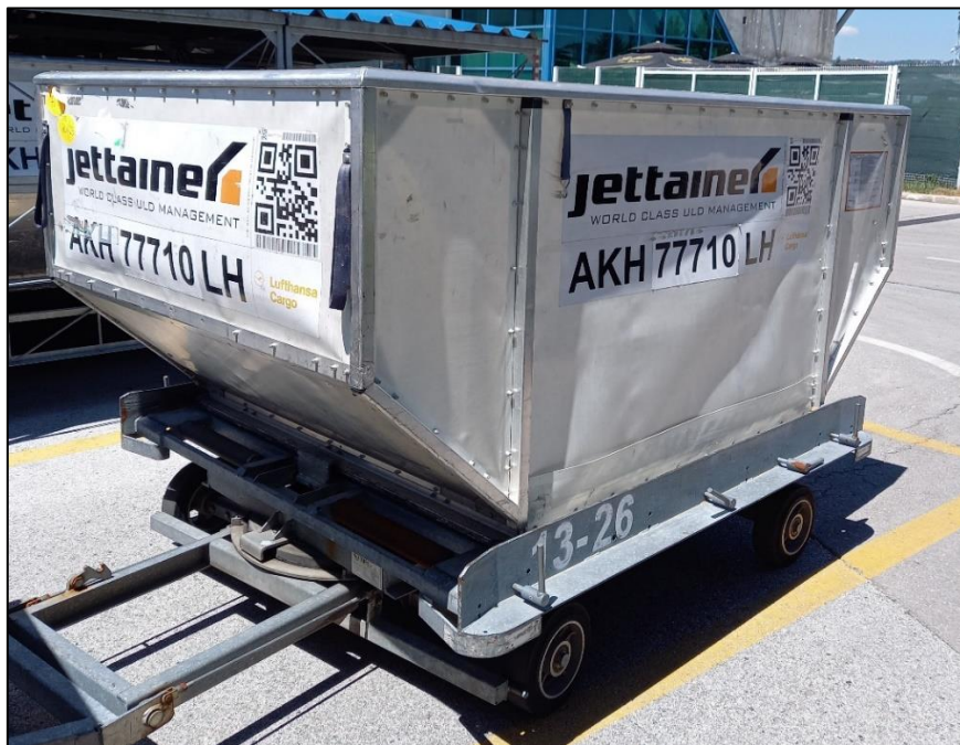
Slika 3: Prikaz ULD kontejnera tipa AKH
