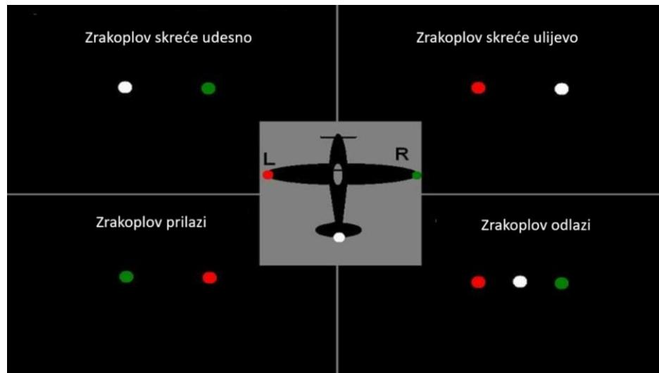
Slika 17. Navigacijska svjetla na zrakoplovu
