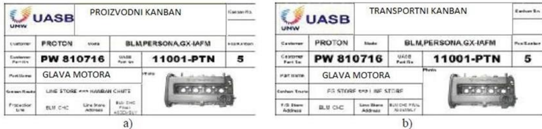
Slika 7. Primjer Kanban kartica; a) Kartica za proizvodni Kanban b) Kartica za transportni Kanban
