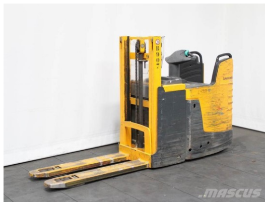
Slika 21. Električni viličar namijenjen skladišnim poslovima
