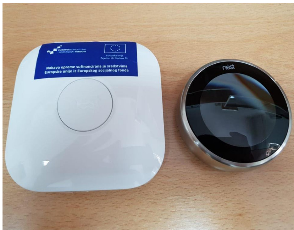
Slika 9. Heat Link (lijevo) i Nest pametni termostat (desno), (senzori u sklopu Laboratorija za modeliranje i optimiranje informacijsko-komunikacijskih mreža i usluga na Fakultetu prometnih znanosti)
