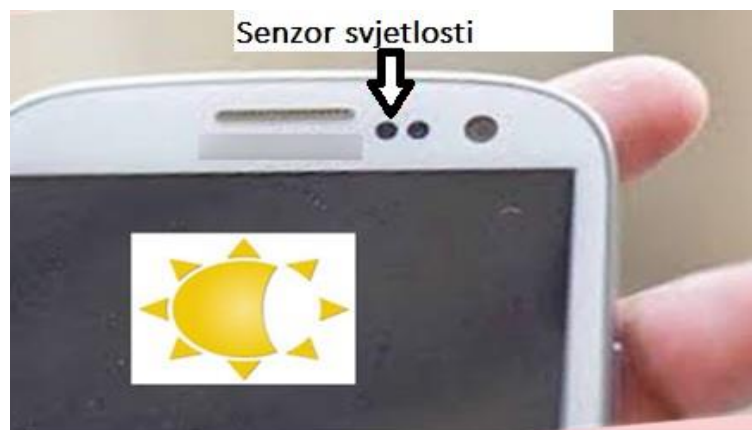
Slika 20. Prikaz pozicije senzora svjetlost.
