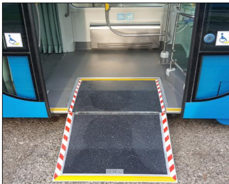
Slika 11. Rampa za osobe s invaliditetom u javnom gradskom prometu grada Zagreba.
