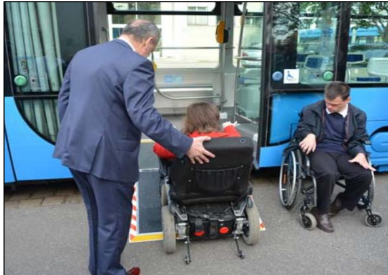
Slika 12. Primjer ulaska osobe s invaliditetom pomoću rampe u tramvaj. Izvor: [24]
