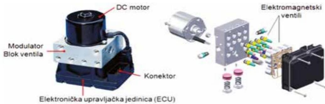
Slika 11. Komponente hidrauličko-elektroničke upravljačke jedinice [5]
