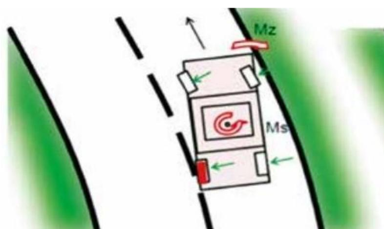
Slika 3. Zanošenje vozila prednjim dijelom (podupravljivost) [5]
