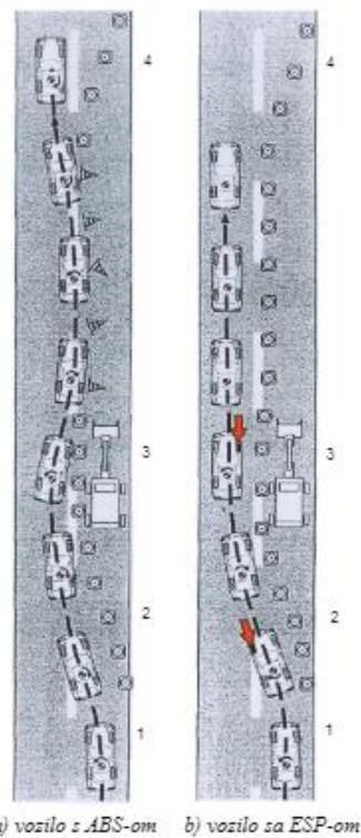
**Slika 19. Promjena trake na kolniku pri potpunom kočenju bez i sa ESP-om [10]**
