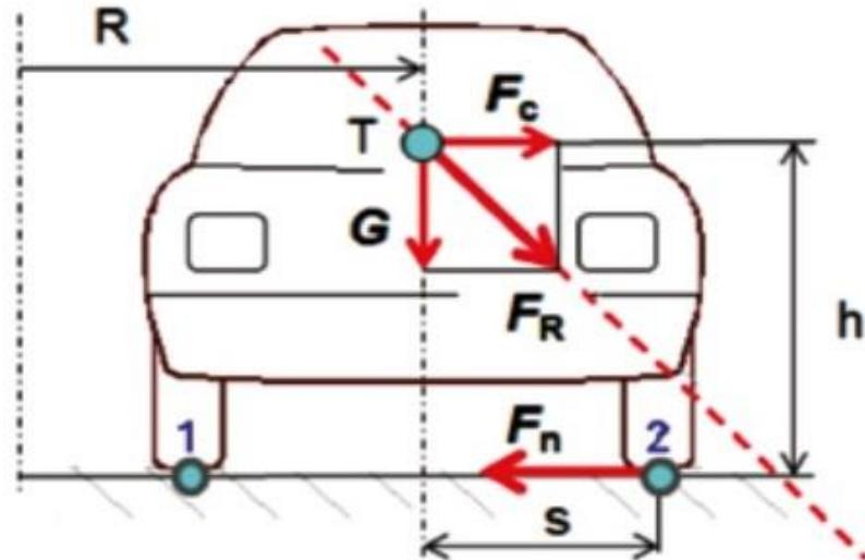
Slika 5. Ovisnost prevrtanja vozila o rezultantnoj sili [5]
