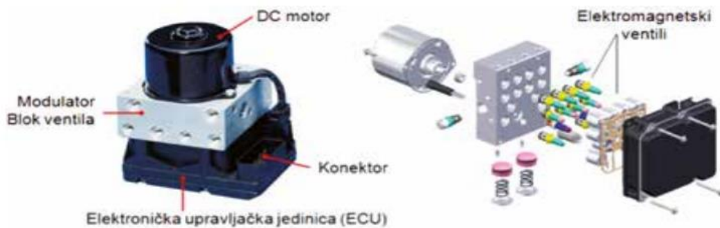
Slika 11. Komponente hidrauličko-elektroničke upravljačke jedinice [5]
