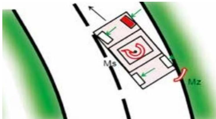
Slika 4. Zanošenje stražnjim dijelom (preupravlјivost) [5]
