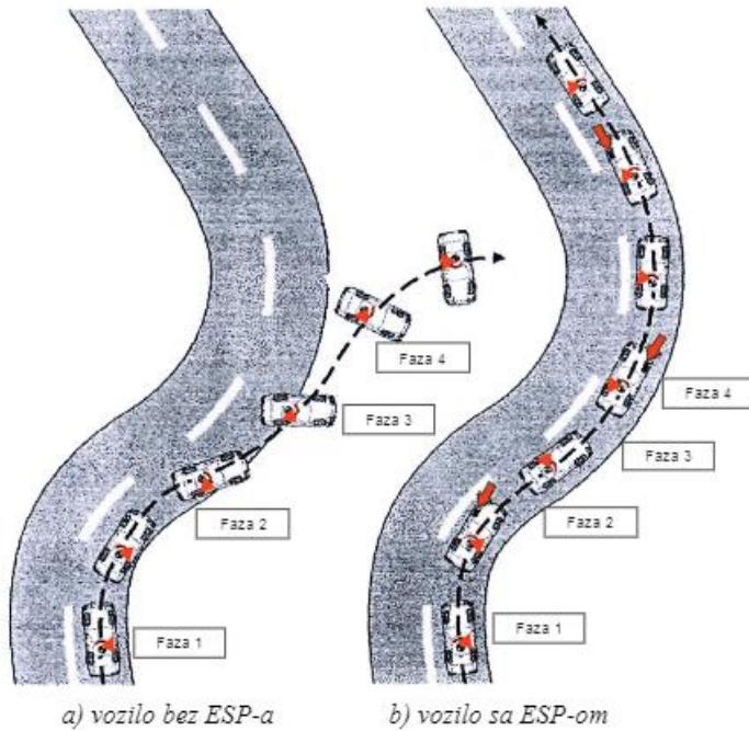
Slika 18. Ponašanje vozila u desnom i lijevom zavoju kod brzog upravljanja i protuupravljanja [10]
