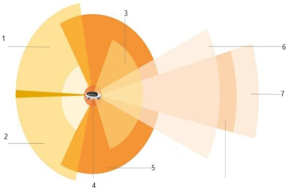
**Slika 7.** Raspored senzora i kamera kod Teslinih vozila, [15]
