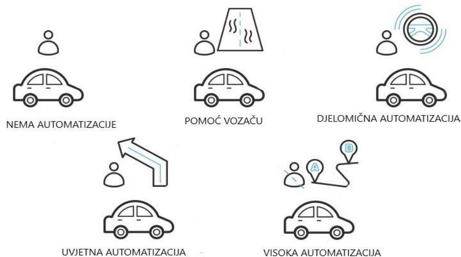
Slika 6. Razine autonomnosti vozila, [10]
