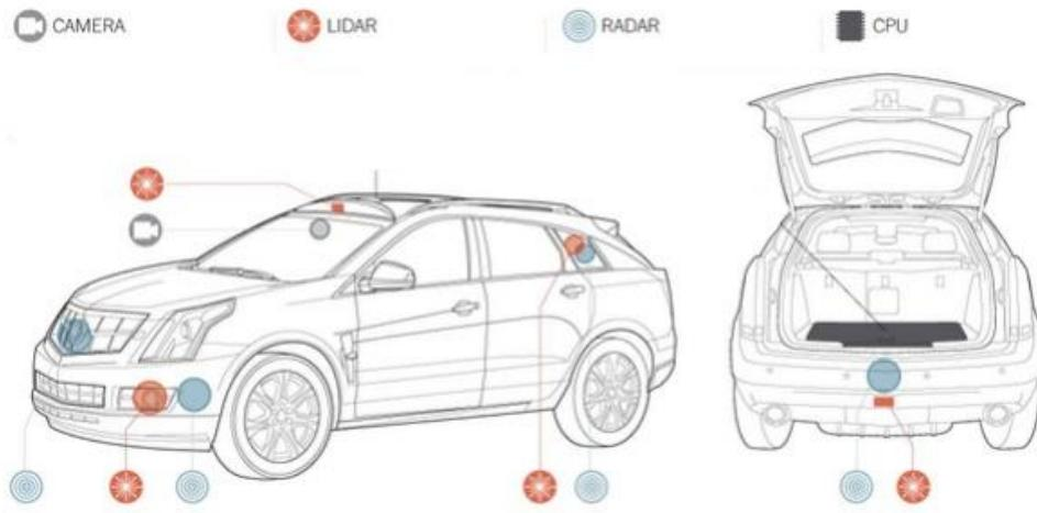
**Slika 4.** Raspored senzora na automobilu, [11]
