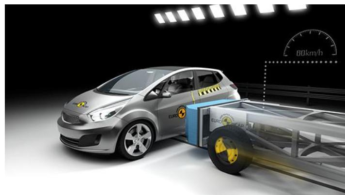
Slika 9. Prikaz bočnog sudara s pokretnom deformabilnom barijerom, [10]
