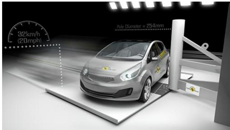
Slika 10. Prikaz bočnog udara u stup, [11]
