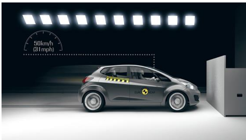
Slika 8. Prikaz udara punom širinom u nepomičnu barijeru, [9]
