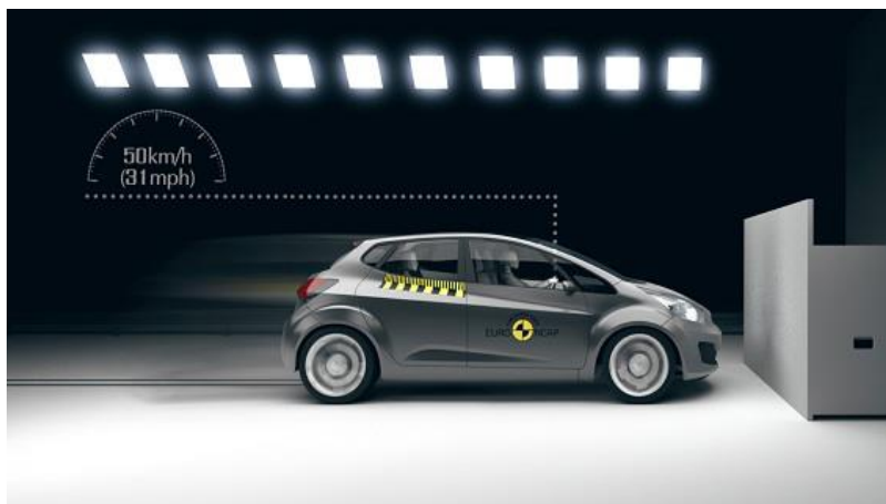
Slika 8. Prikaz udara punom širinom u nepomičnu barijeru, [9]
