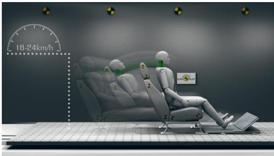
Slika 12. Prikaz testiranja naglog trzaja glavom, [12]
