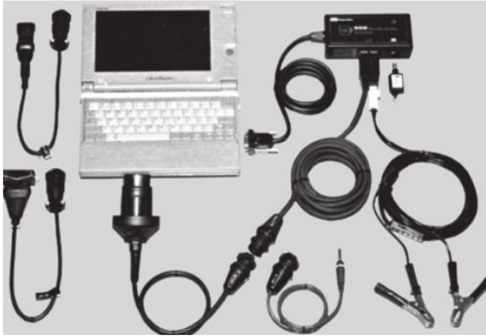
Slika 30. Programni skener s osobnim računalom
