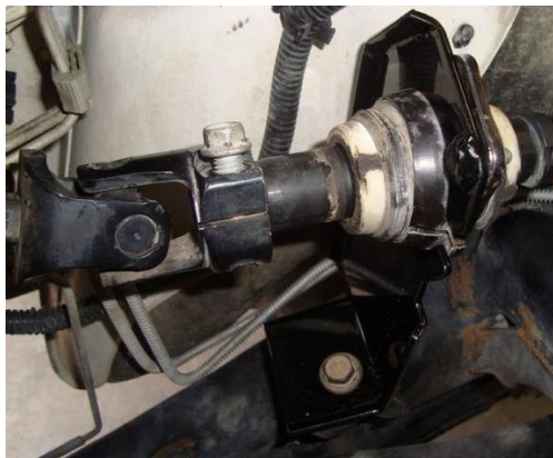
Slika 4. Spoj upravljača i upravljačkog stupa
