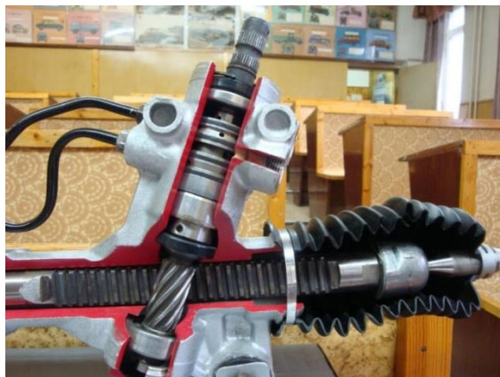
Slika 14. Mehanički prijenosnik sa zupčastom letvom upravljača
