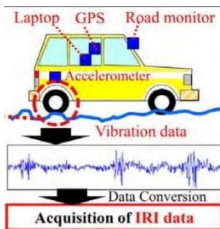
Slika 23: Vozilo sa opremom za IRI mjerenja
