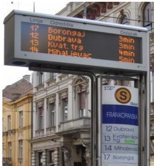
Slika 1. Prikaz displeja koji daje informaciju o vremenu čekanja do dolaska vozila javnog gradskog prijevoza na postaju.
