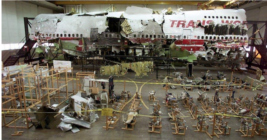
Slika 2. 3D rekonstrukcija olupine zrakoplova. Izvor: [9]
