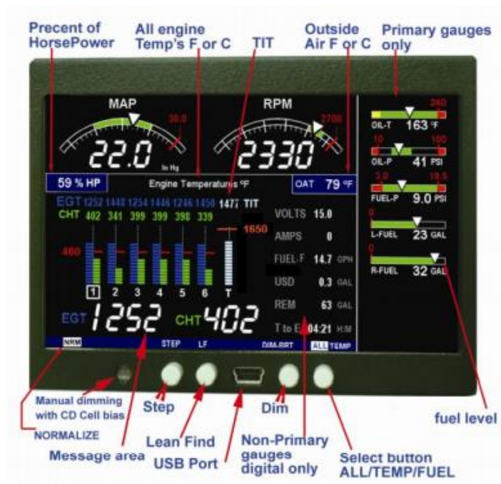
Slika 6. Horizontalni izgled i dijelovi prikaznika [6]
