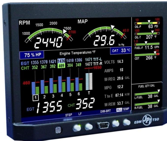
Slika 5. Izgled uređaja EDM 900 [5]
