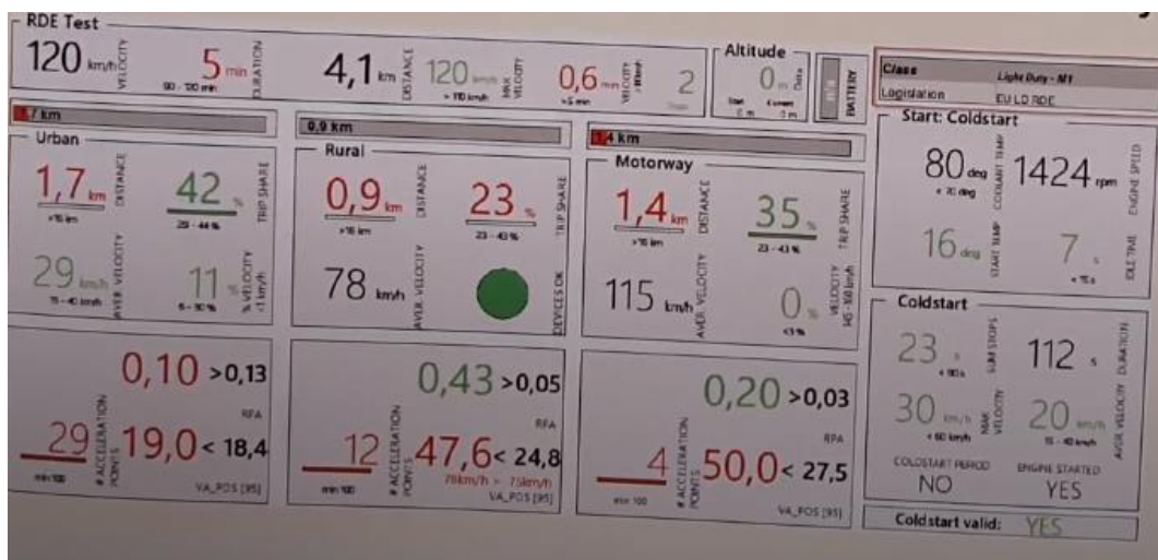
Slika 8 Prikaz rezultata mjerenja pomoću sustava PEMS na cestovnom vozilu
