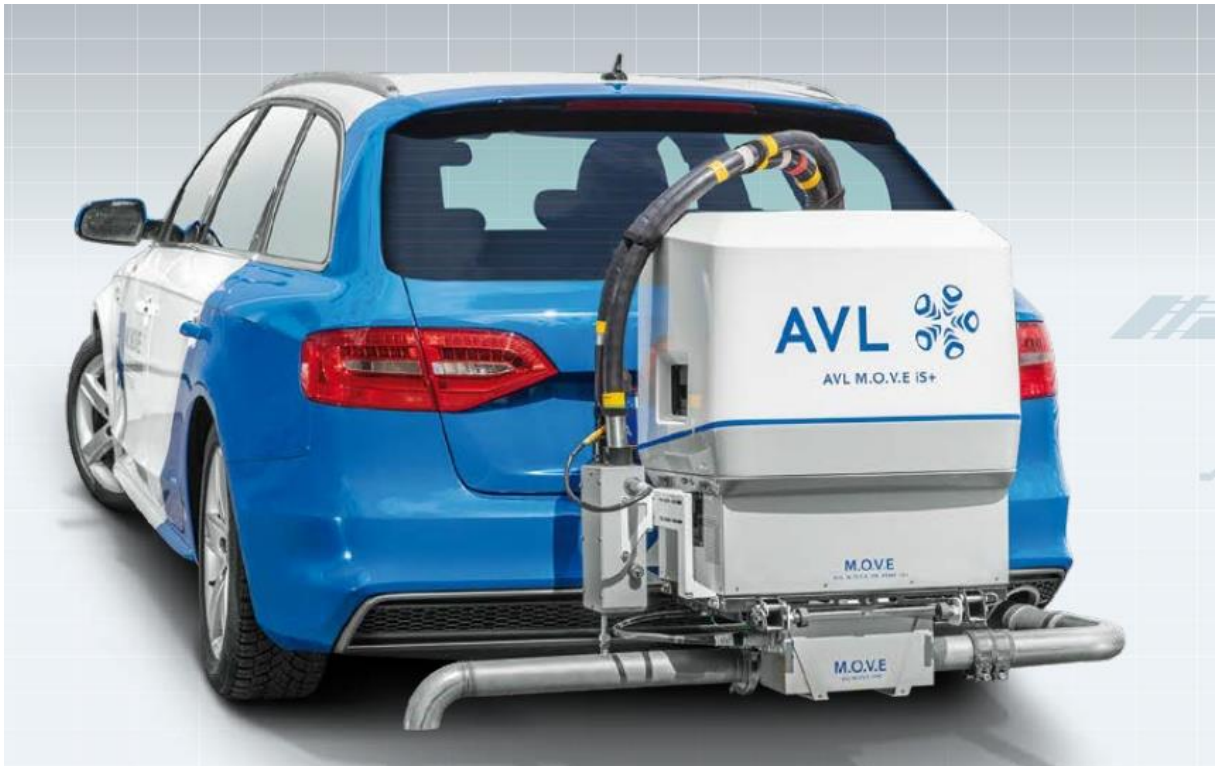
Slika 14 PEMS sustav postavljen na cestovnom vozilu [8]
