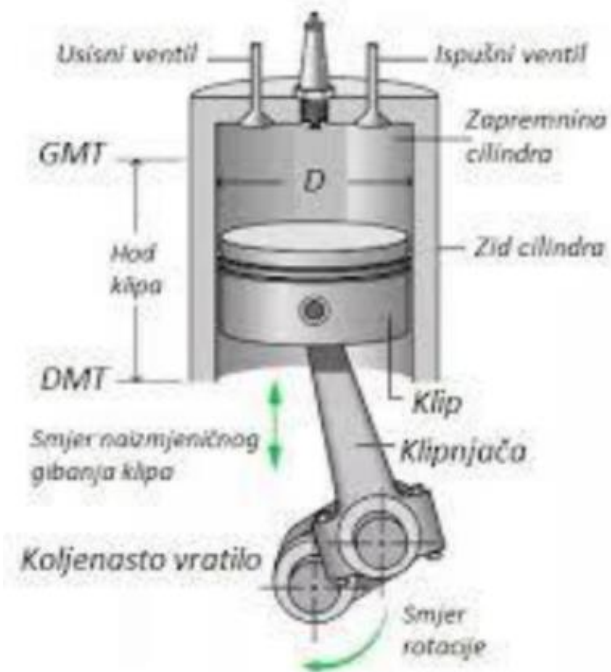
Slika 1 zrakoplovnog klipnog motora s označenim glavnim dijelovima [1]
