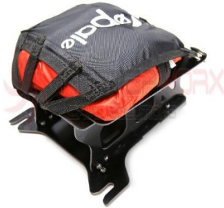
Slika 8 Kopterworx padobran za bespilotnu letjelicu sa nosačem Izvor [21]
