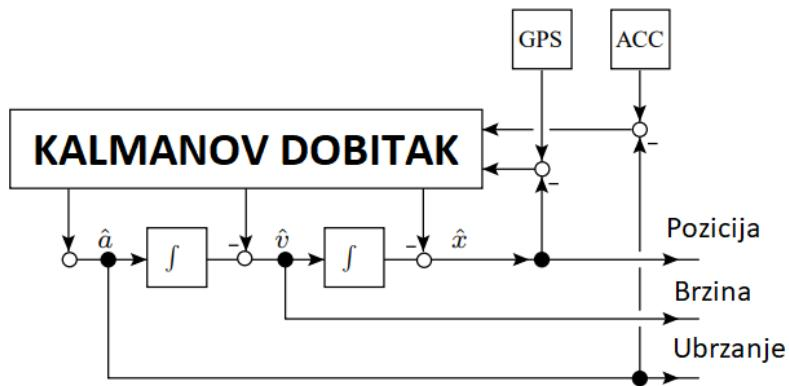
**Slika 8.** Blok-shema izravne metode Kalmanovog filtra
