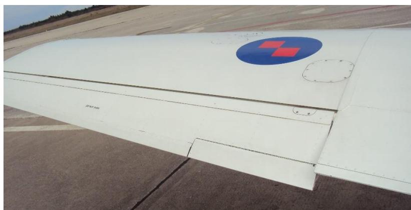
Slika 5.1. Krilca na zrakoplovu Pilatus PC-9M
