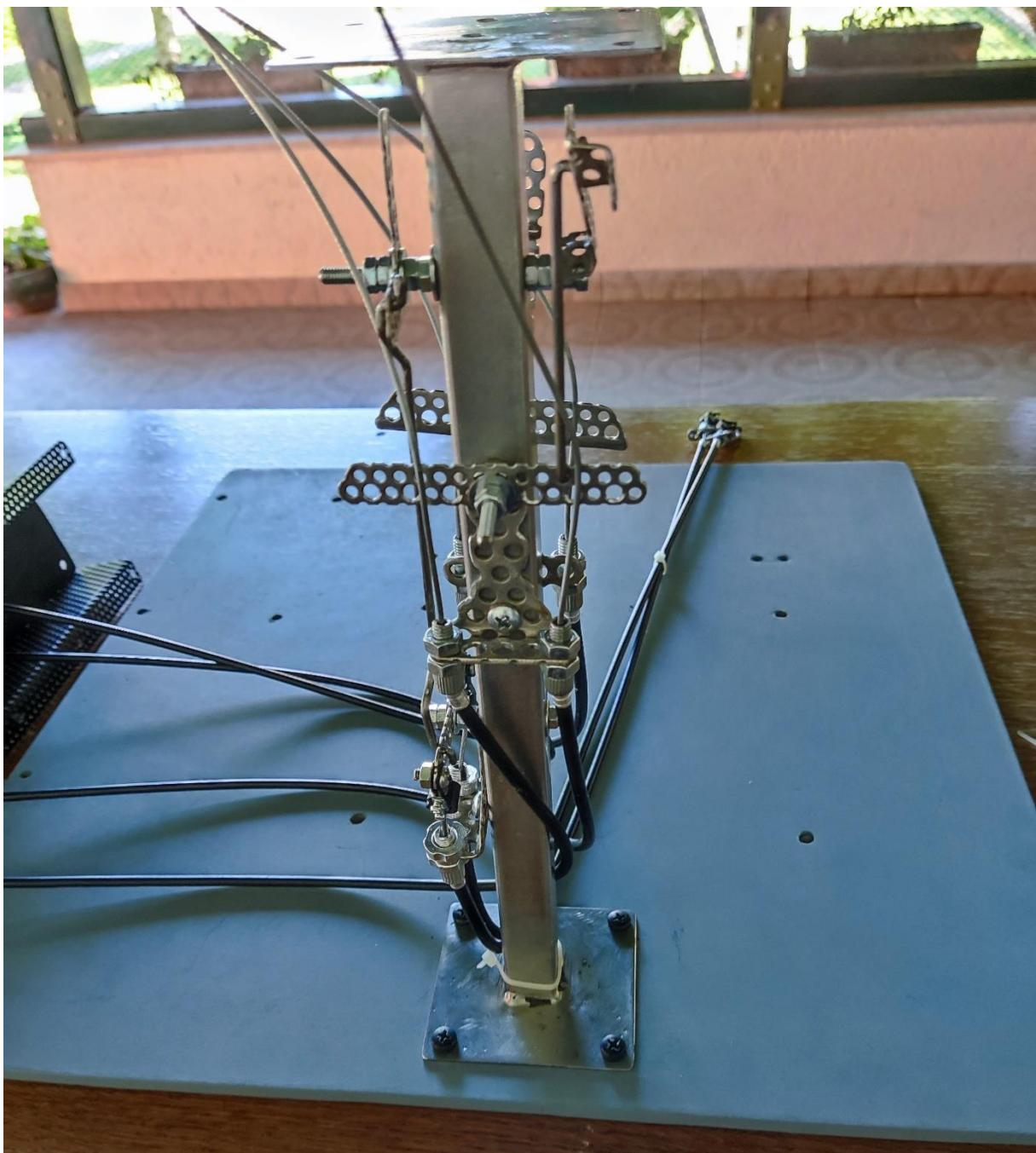
Slika 10.7. a) centralni stup sa prijenosnim mehanizmima na postolju
