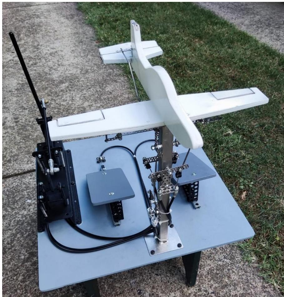
Slika 10.7. d) Potpuno dovršeni model upravljačkih površina zrakoplova
