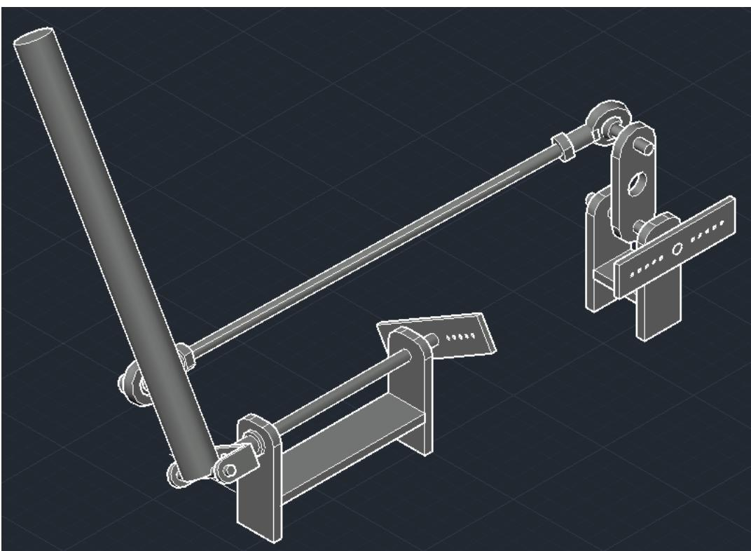
Slika 9.2. d) Mehanizam palice sa otklonom palice  $30^\circ$  u lijevu stranu
