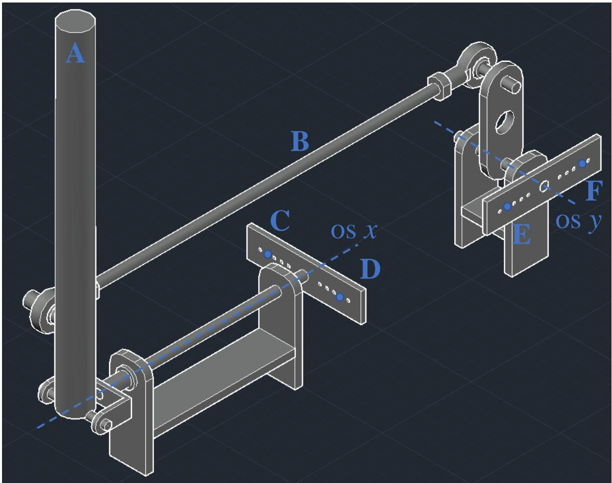
Slika 9.2. a) Mehanizam palice u neutralnom položaju
