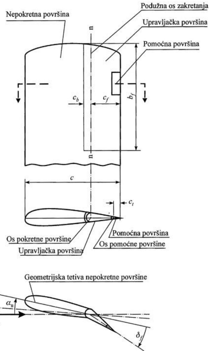
Slika 3.2. Opća shema upravljačke površine [3]
