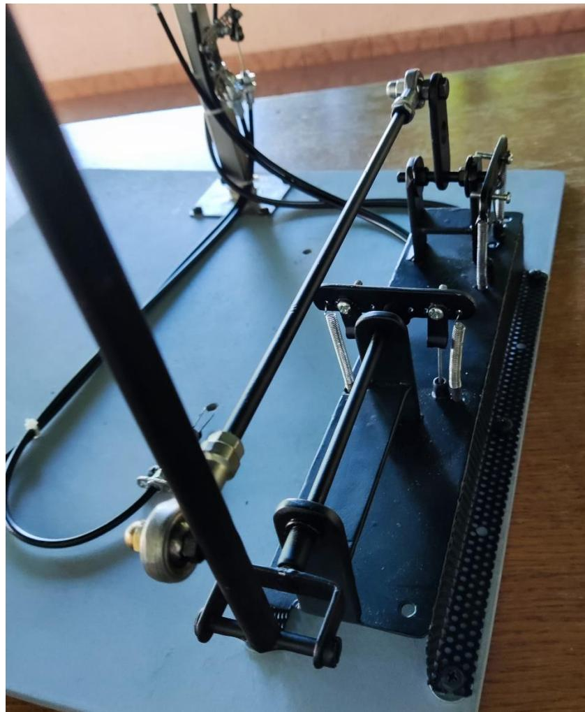
Slika 10.1. b) Završeni mehanizam palice na postolju
