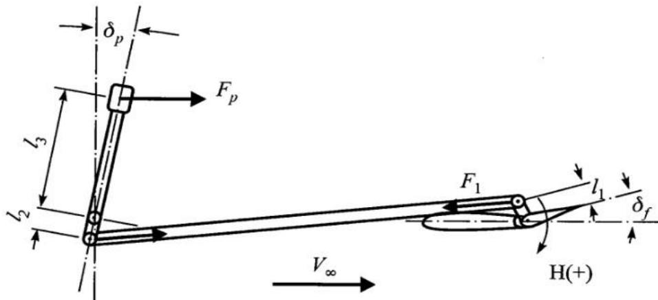
Slika 4.1. Shema prijenosa djelovanja od upravljačke poluge do upravljačke površine
