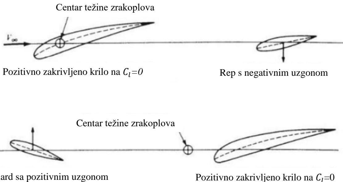
Slika 5.3. Konvencionalni horizontalni stabilizator i kanard krilo [3]
