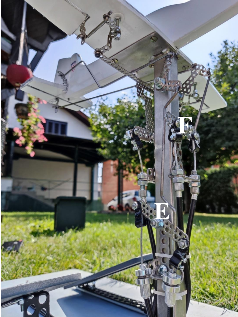
Slika 10.6. d) Prijenosni mehanizam pomaka nožnih komandi na centralnom stupu
