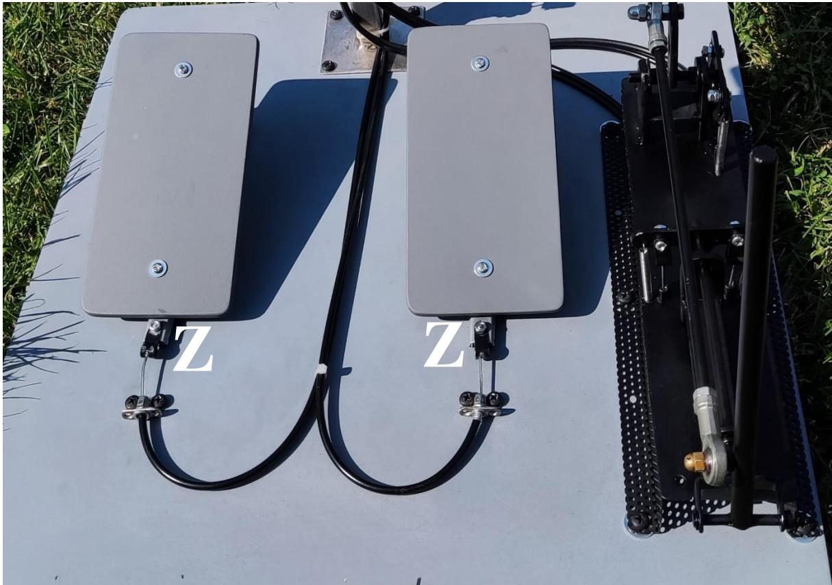
Slika 10.5. Nožne komande i mehanizam palice na postolju
