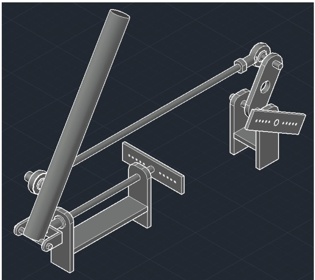
Slika 9.2. c) Mehanizam palice sa otklonom palice  $30^\circ$  prema naprijed
