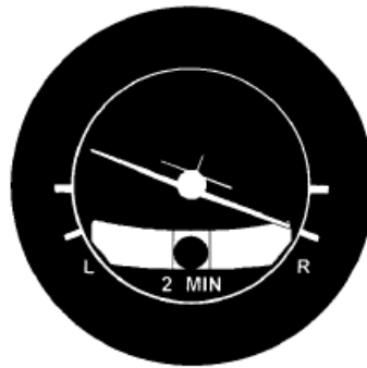
Slika 7. Avion u koordiniranom zaokretu Izvor: [2]
