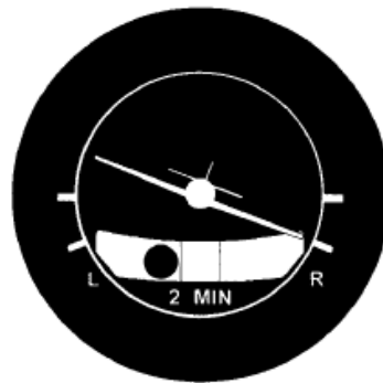
Slika 9. Avion u desnom nekoordiniranom zaokretu Izvor: [2]
