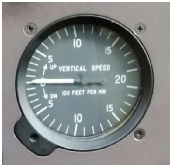
Slika 9. Variometar iz zrakoplova Zlin 242L
