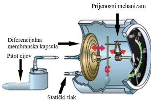
Slika 6. Prikaz presjeka brzinomjera za indiciranu brzinu [4]
