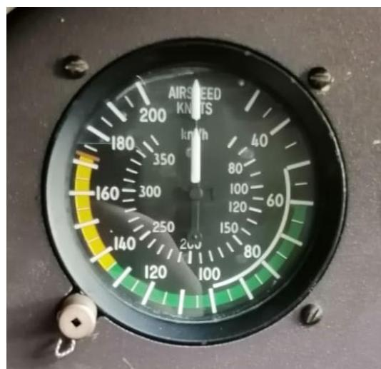
Slika 7. Brzinomjer iz zrakoplova Zlin 242L
