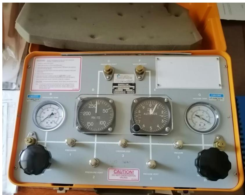
Slika 12. Ispitivački uređaj Barfield 1811 D
