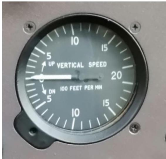
Slika 9. Variometar iz zrakoplova Zlin 242L
