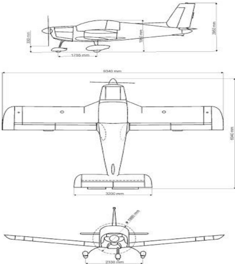
Slika 1. Ortagonalna projekcija zrakoplova Zlin 242L [8]
