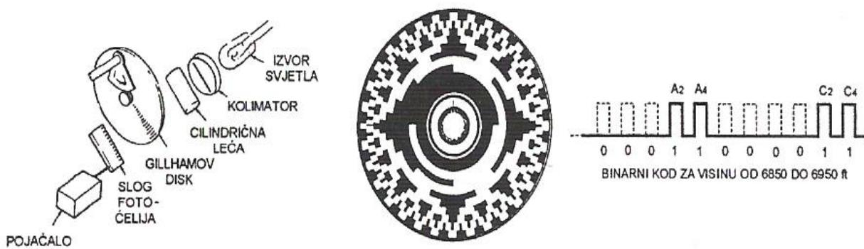
Slika 5. Prikaz načina rada kodirajućeg barometarskog visinomjera [1]
