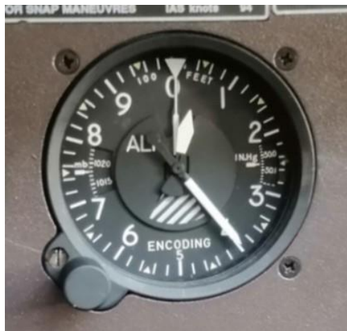
Slika 4. Kodirajući visinomjer iz zrakoplova Zlin 242L
