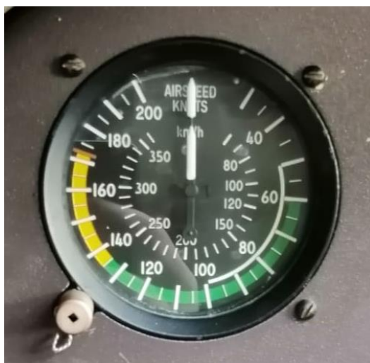
Slika 7. Brzinomjer iz zrakoplova Zlin 242L
