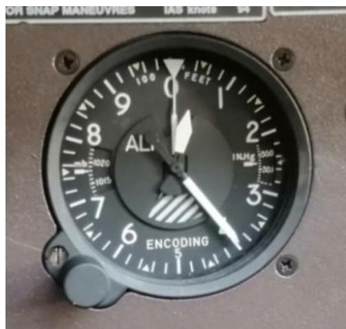
Slika 4. Kodirajući visinomjer iz zrakoplova Zlin 242L
