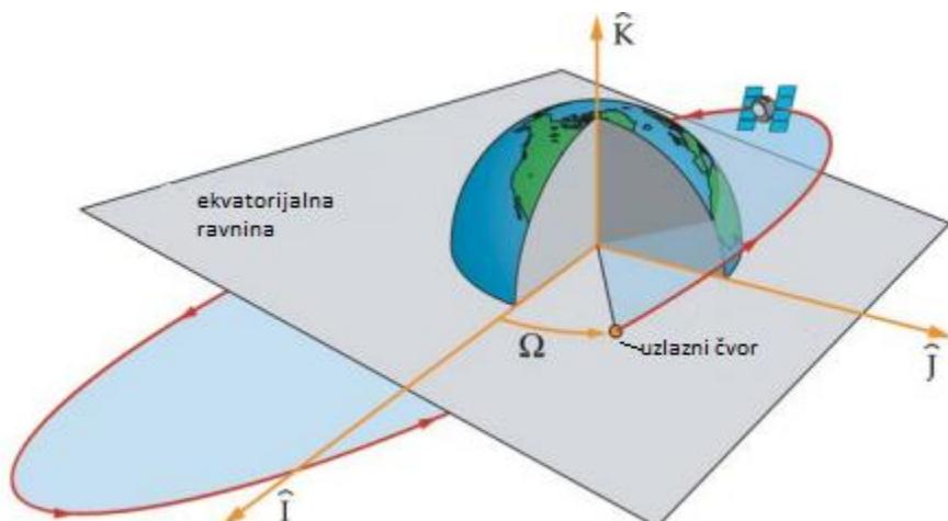
Slika 7. Kut desnog uzdizanja uzlaznog čvora
