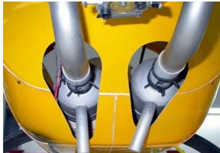
**Slika 33.** Prikaz ugradnje ispušnog sustava
