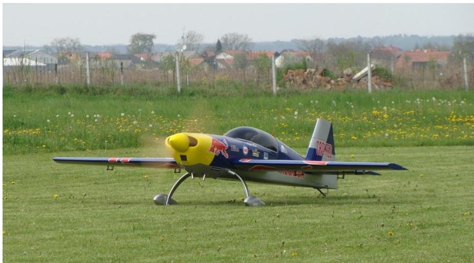
**Slika 51.** Ispitivanje podvozja modela zrakoplova Extra 330l
