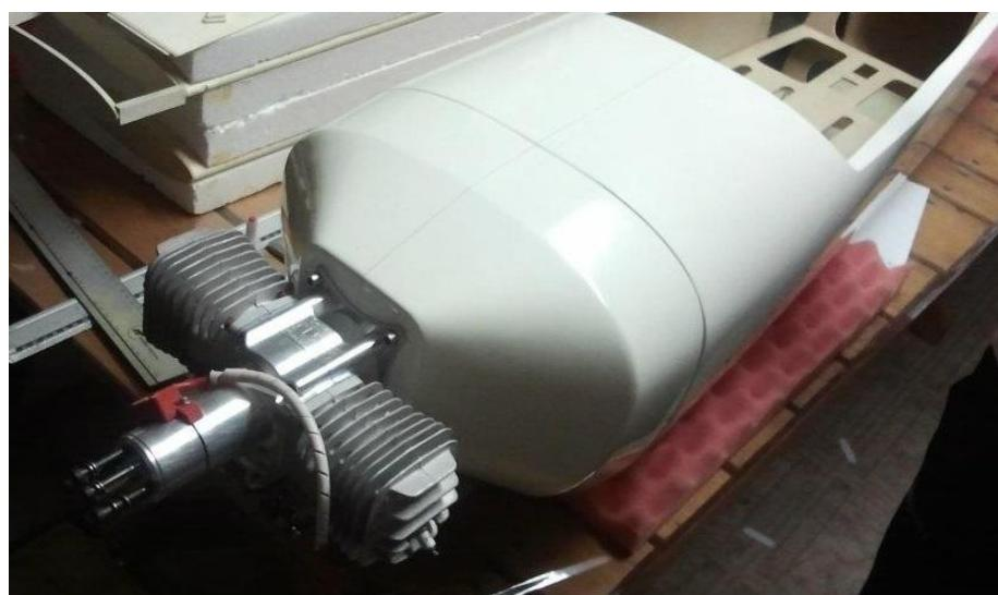
**Slika 32.** Prikaz ugradnje pogonskog sustava
