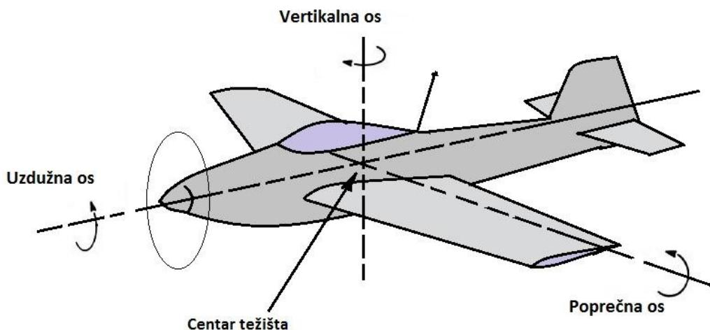
Slika 15. Prikaz osi bespilotne letjelice
