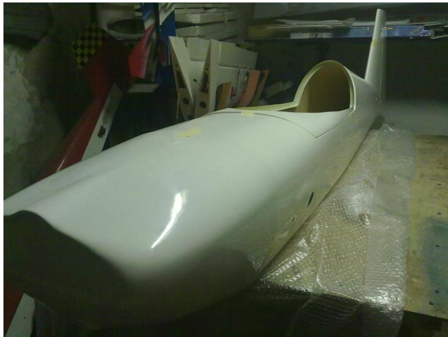
**Slika 25.** Izrađen trup modela zrakoplova Extra 330l
