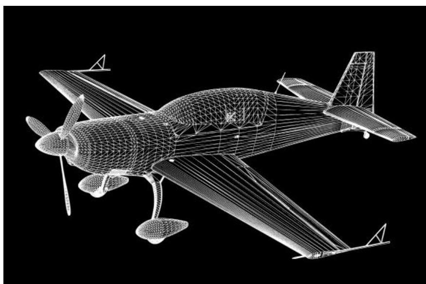
Slika 23. Prikaz generiranog 3D modela zrakoplova Extra 330I
