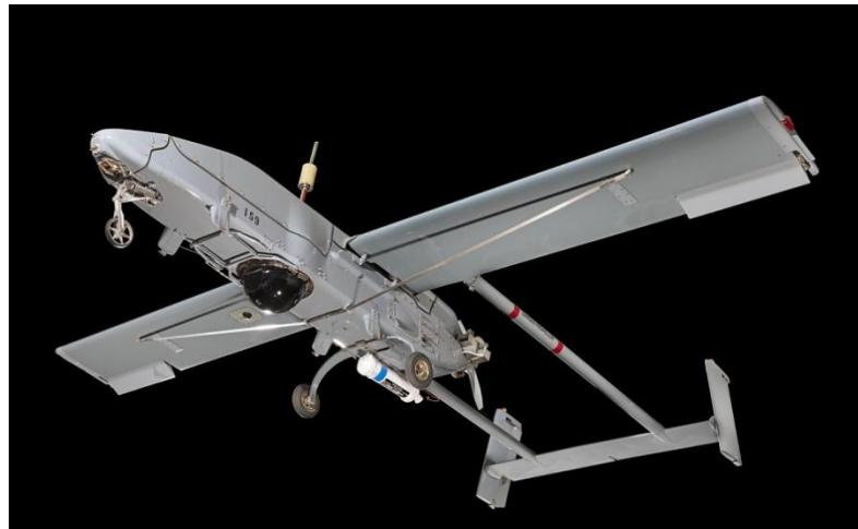
**Slika 8.** Bespilotna letjelica RQ-2A
