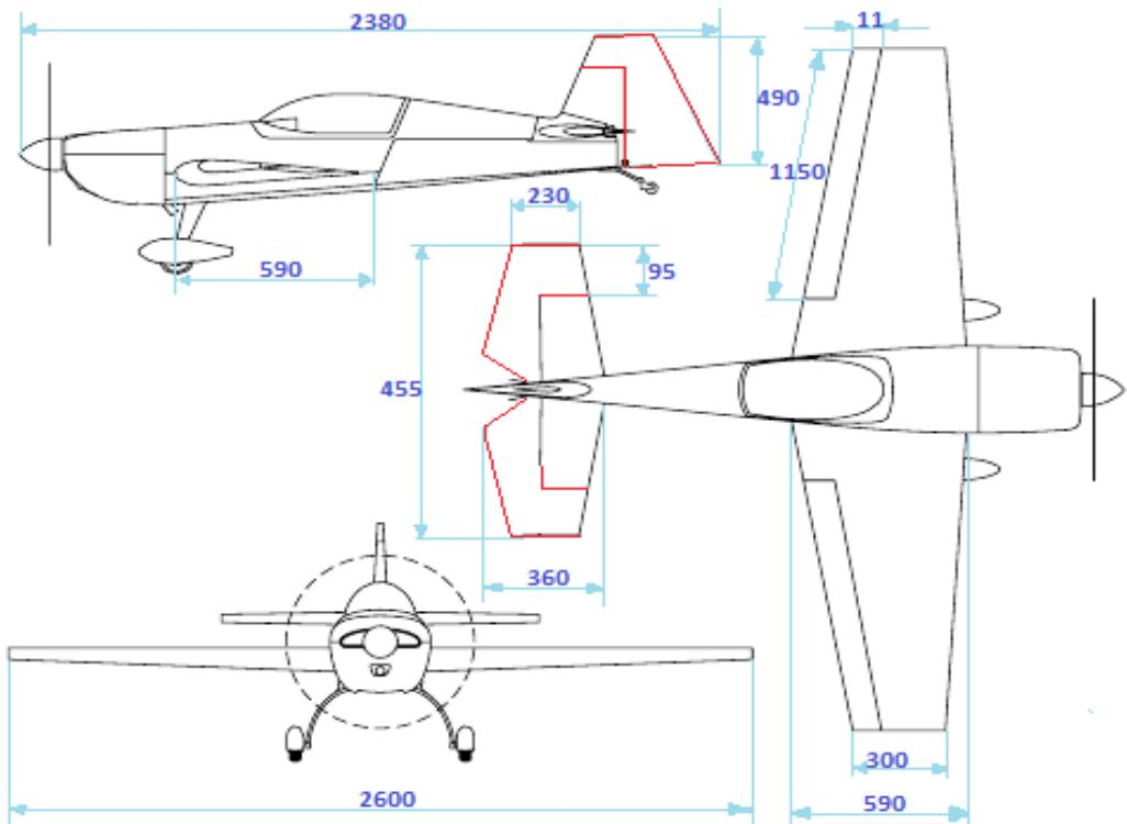
**Slika 21.** Prikaz dimenzija modela zrakoplova Extra 330l
