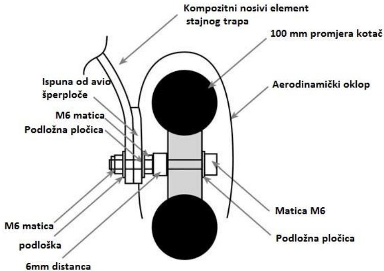
**Slika 31.** Presjek konstrukcije podvozja
