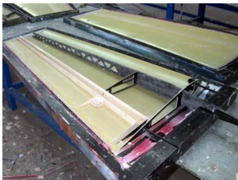
Slika 27. Prikaz procesa izgradnje krila modela zrakoplova Extra 3301
