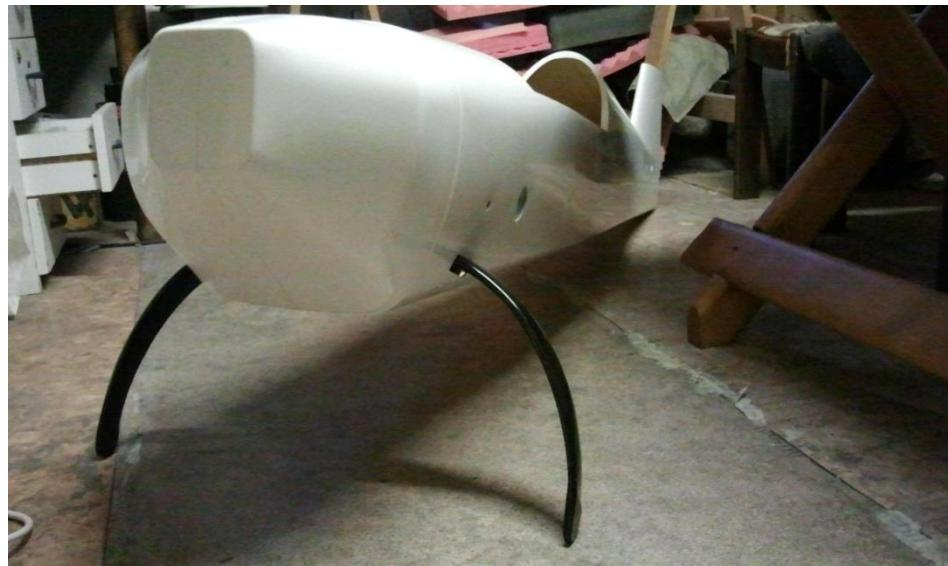
**Slika 26.** Prikaz stajnog trapa modela zrakoplova Extra 330l
