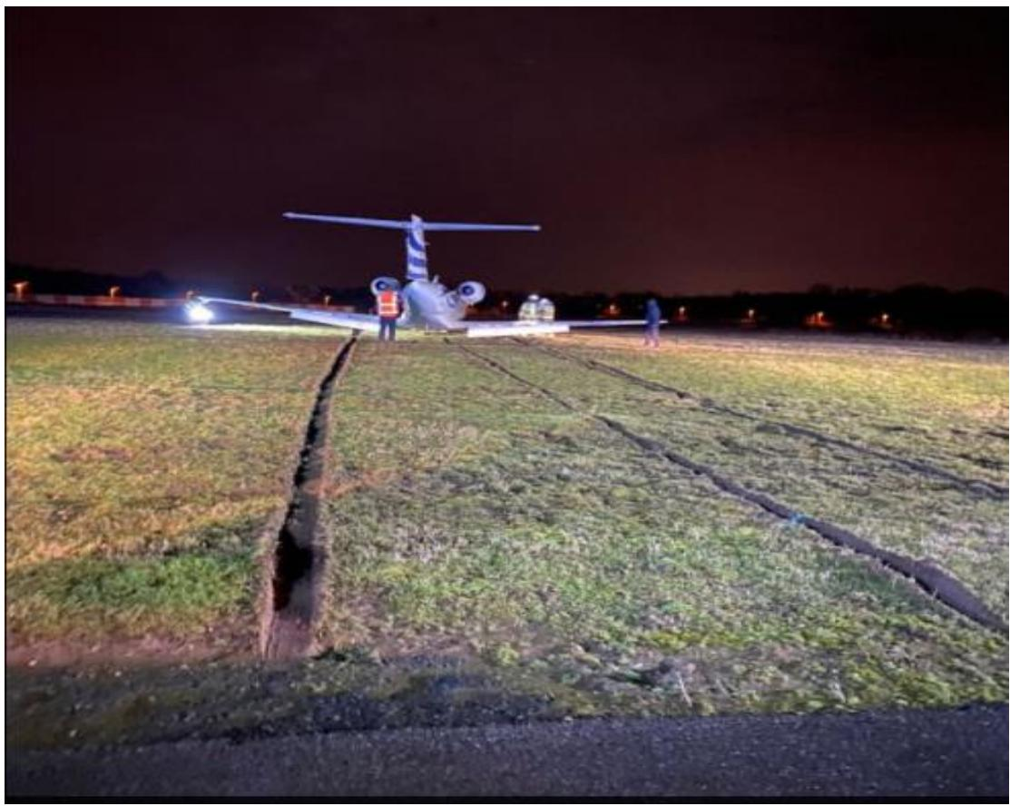
Slika 5. Trag klizanja zrakoplova po zemlji, [19]
