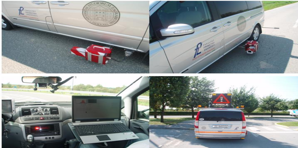
Slika 17. Uređaj i oprema za mjerenje noćne vidljivosti oznaka na kolniku
