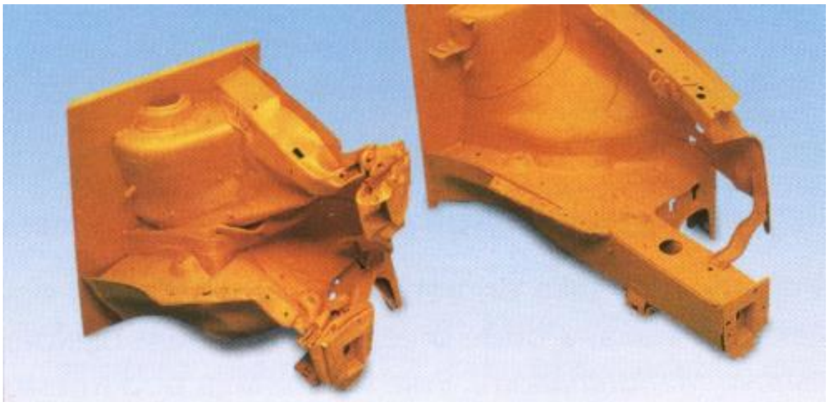
Slika 2-21 Deformacijsko ponašanje prednjeg uzdužnog nosača, [2]
