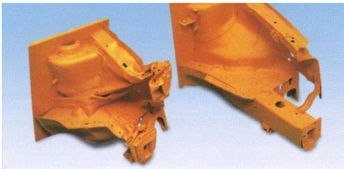
Slika 2-21 Deformacijsko ponašanje prednjeg uzdužnog nosača, [2]
