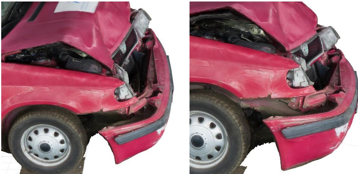
Slika 6-9 Prikaz mogućnosti fotogrametrije za određivanje oštećenja
