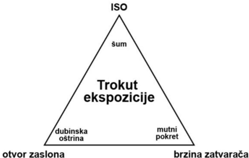
Slika 3-1 Međuovisnost otvora zaslona - brzine zatvarača - ISO osjetljivost, [22]
