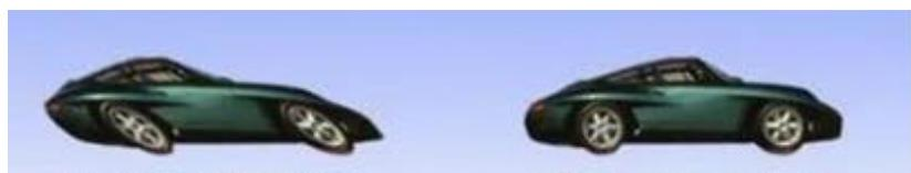
Slika 5-2 Razlika između klasičnog i mehaničkog zatvarača kamere [28]
