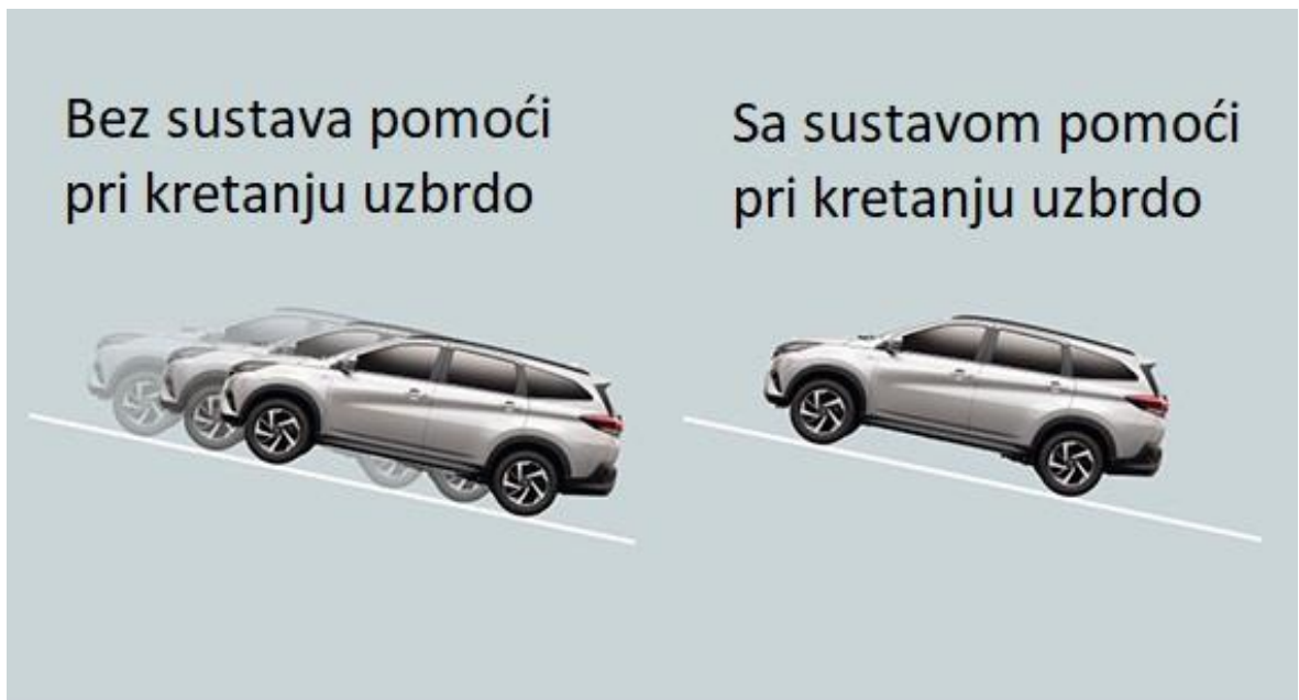
Slika 9. Razlika sa i bez HAC sustava [16]
