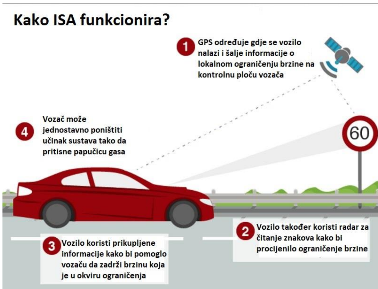
Slika 6. Način rada ISA sustava [11]
