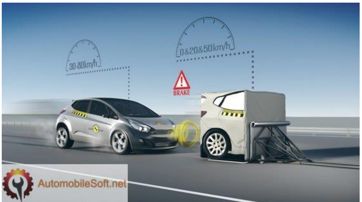
Slika 5. Princip rada AEBS sustava [9]
