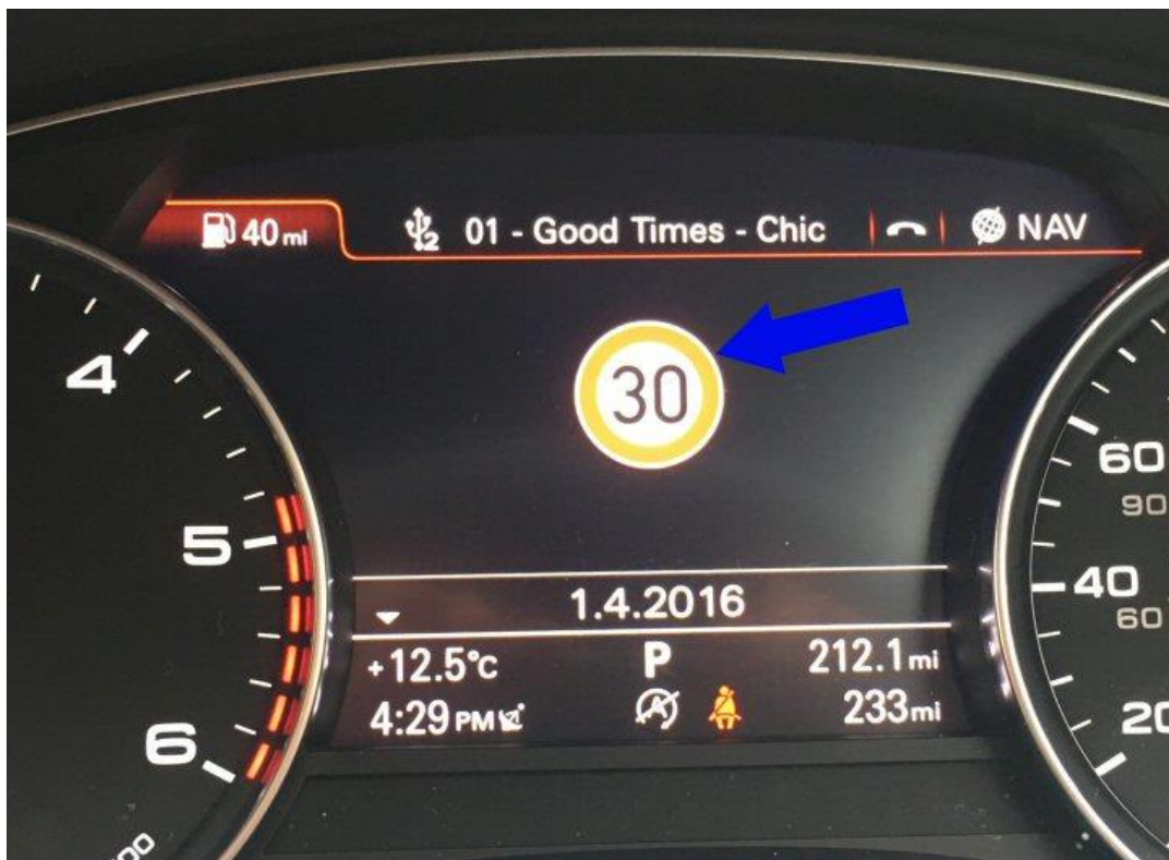
Slika 16. Prikaz sustava za prepoznavanje znakova na instrument ploči vozila Audi A6
